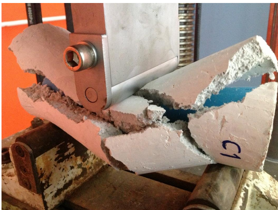
ภาพแสดงการรับแรง โมดูลัสการแตกหักของท่อนซีเมนต์เยื่อกระดาษแกนท่อพีวีซี
