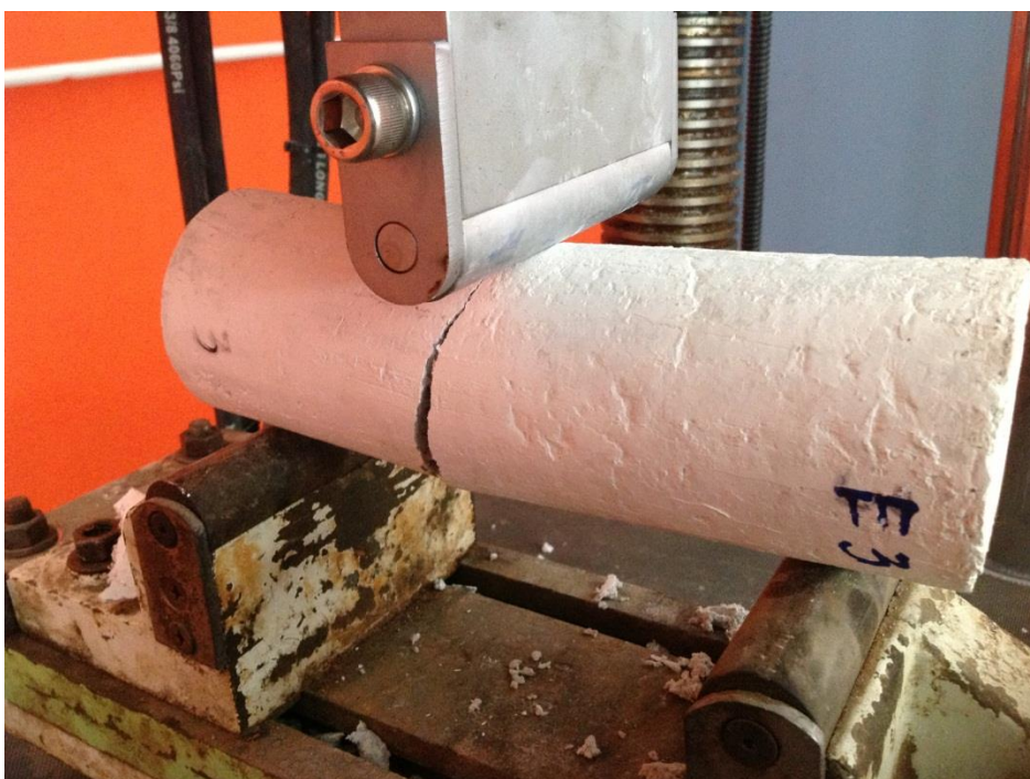
ภาพแสดงการรับแรงโมดูลัสการแตกหักของท่อนซีเมนต์เยื่อกระดาษแกนเหล็กเส้น
