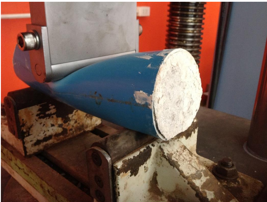
ภาพแสดงการรับแรงโมดูลัสการแตกหักของท่อพีวีซีแกนซีเมนต์เยื่อกระดาษ
