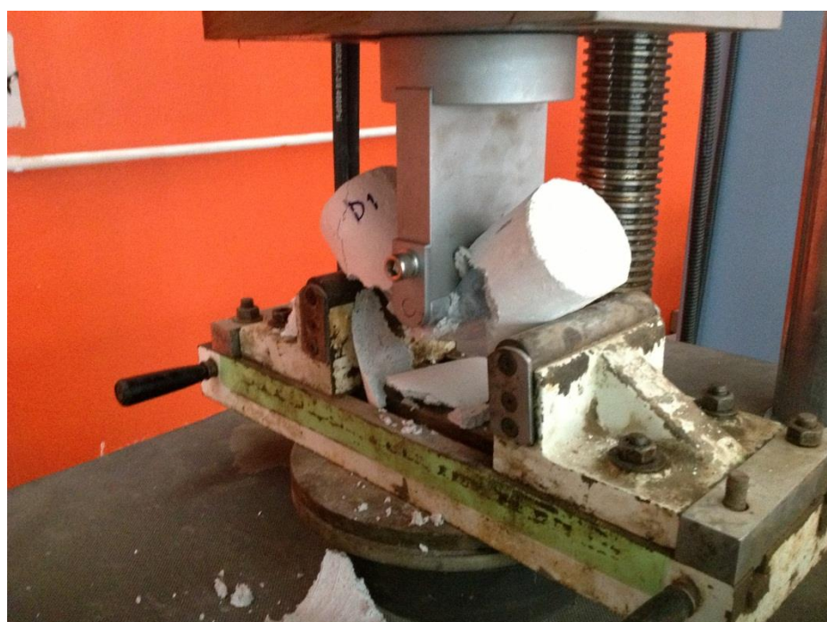
ภาพแสดงการรับแรง โมดูลัสการแตกหักของท่อนซีเมนต์เยื่อกระดาษแกนขวดพลาสติก
