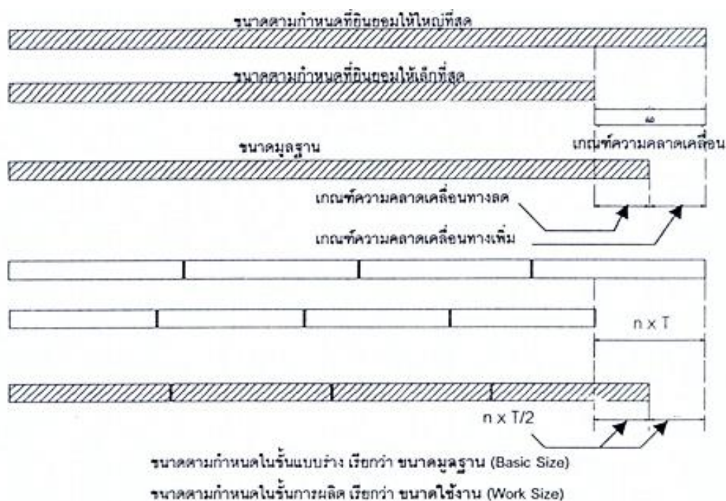
ภาพที่ ก 3 แสดงการกำหนดเกณฑ์ความคลาดเคลื่อนในชิ้นส่วนอาคาร
