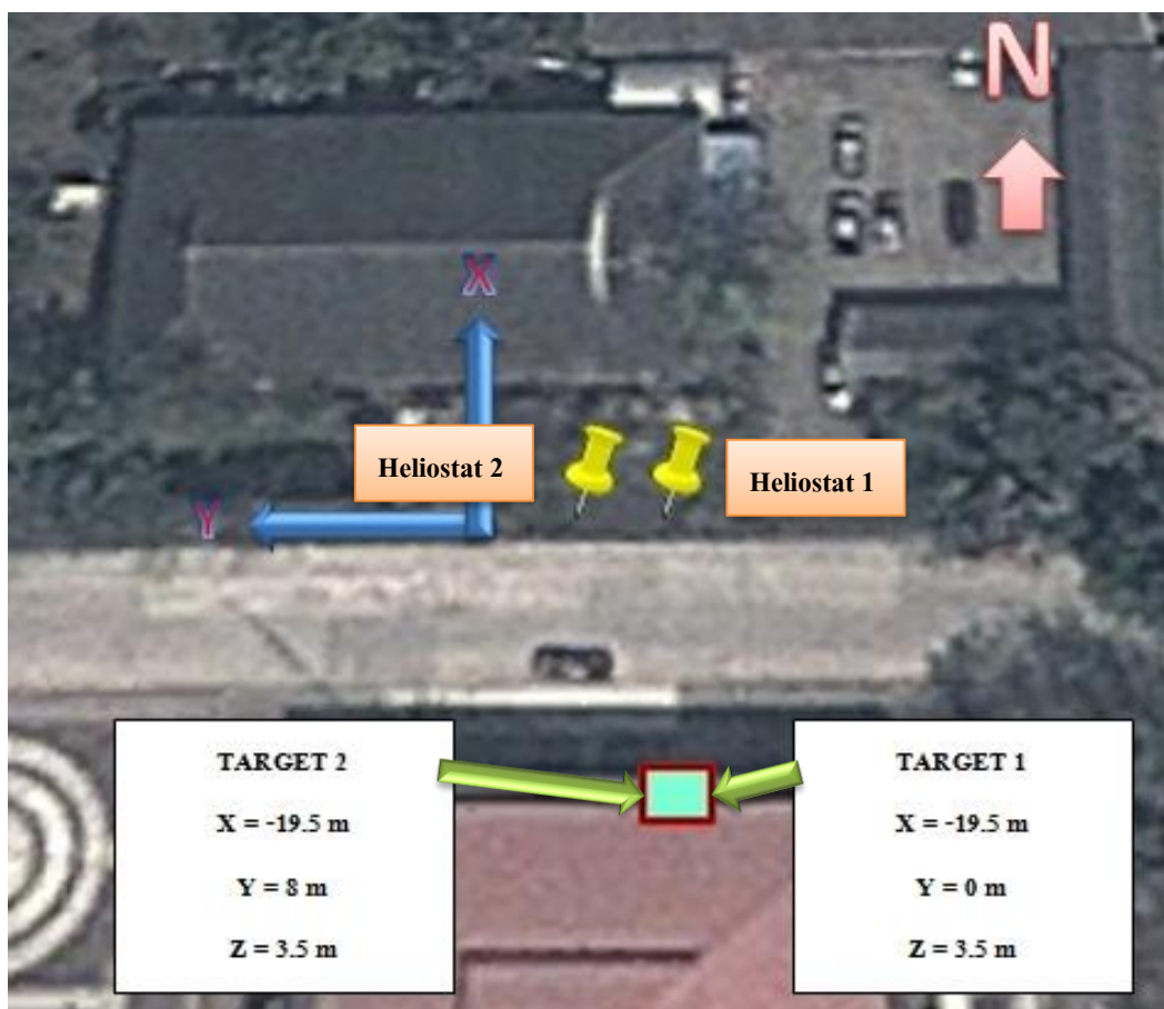
รูปที่ 4.12 ระนาบของระบบสะท้อนแสงอาทิตย์ตัวที่ 1, 2 และตำแหน่งเป้าหมาย
