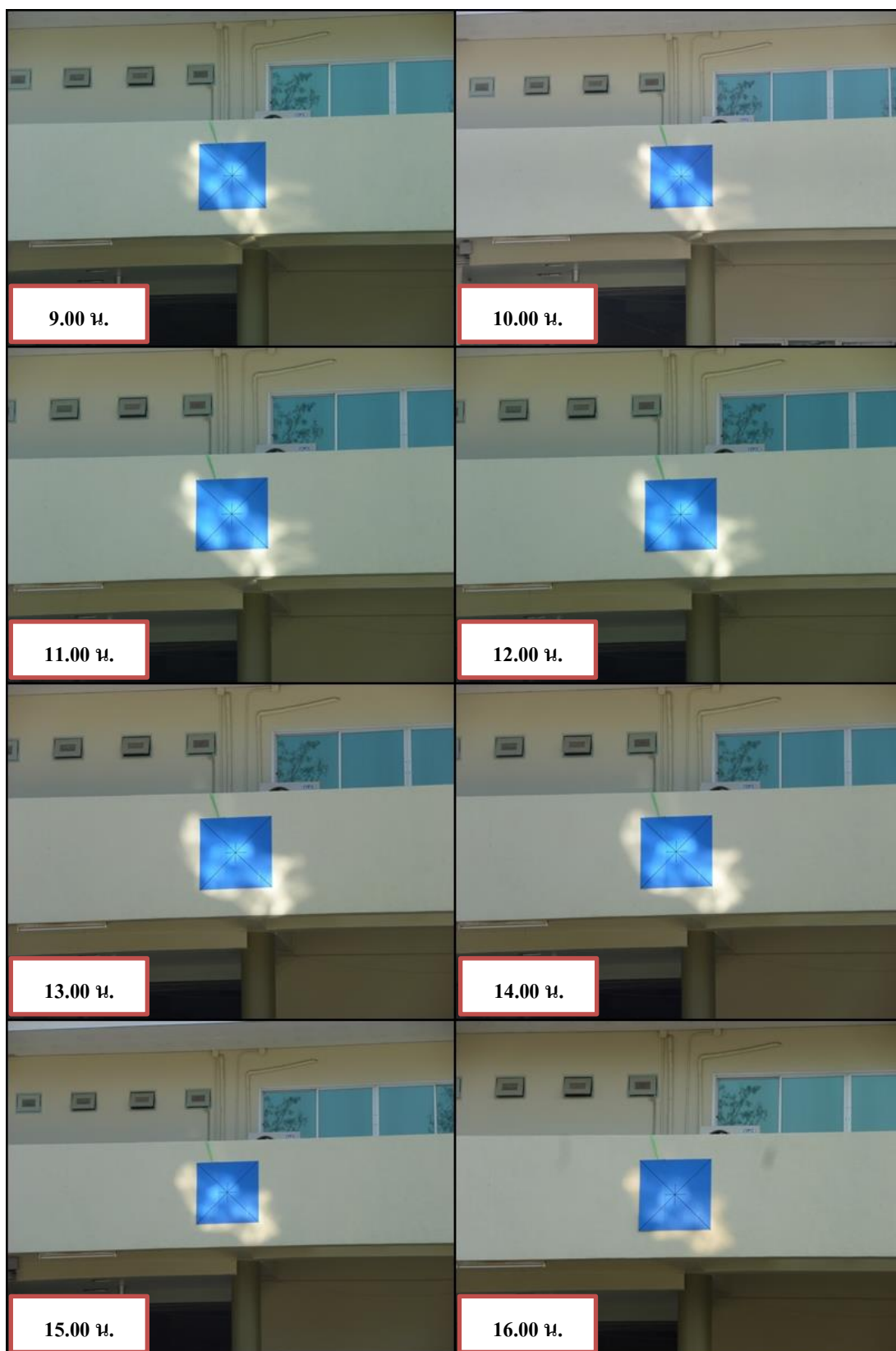
รูปที่ 4.10 ผลการทดสอบการสะท้อนของระบบสะท้อนแสงอาทิตย์ตัวที่ 2
