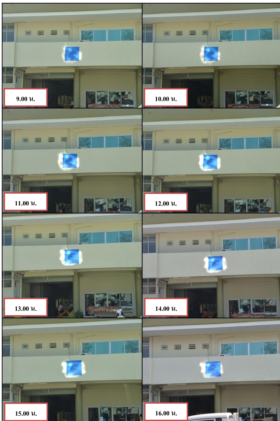
รูปที่ 4.7 ผลการทดสอบการสะท้อนของระบบสะท้อนแสงอาทิตย์ตัวที่ 1
