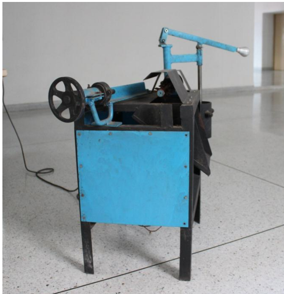
รูปที่ 4.1 เครื่องพอกเปลือกหน่อไม้ขนาดความกว้าง 400x550x700 มิลลิเมตร
