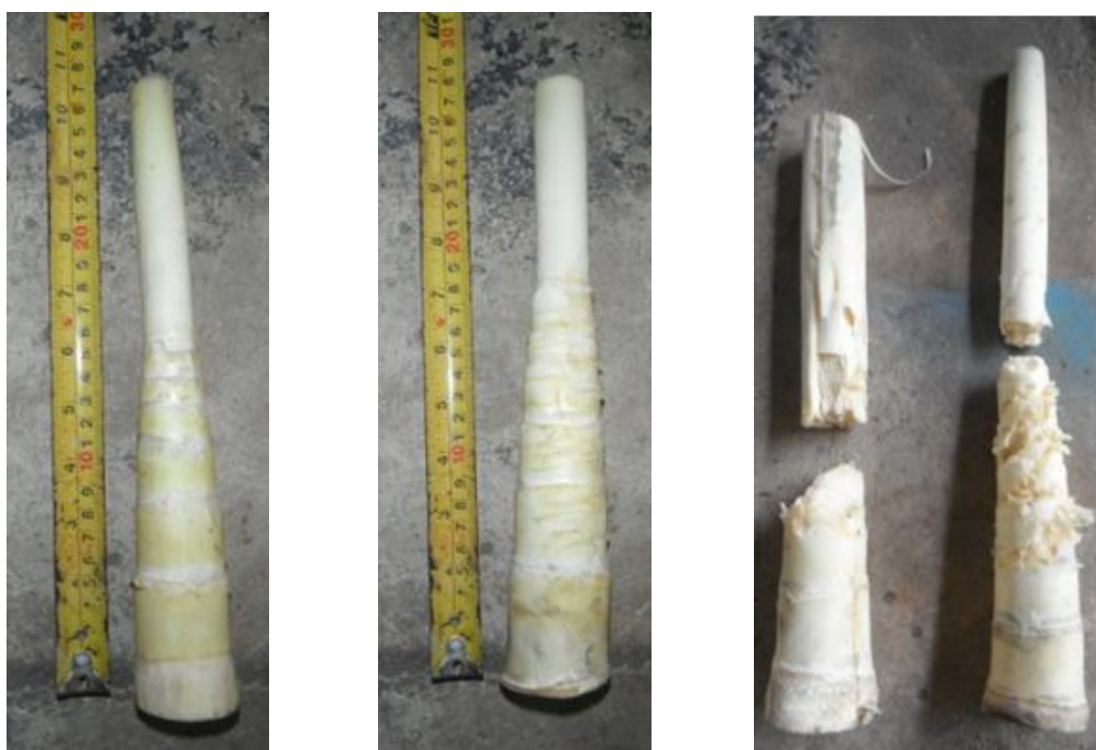
(ก) หน่อไม้ที่ใช้แรงงานคนปอก (ข) หน่อไม้ที่ใช้เครื่องปอก (ค) หน่อไม้ที่เสียหายขณะทำการปอก
