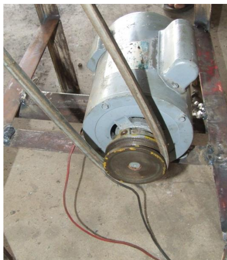
รูปที่ 3.12 มอเตอร์ส่งกำลังขนาด มอเตอร์ขนาด 0.5 แรงม้า 1400 รอบต่อนาที
