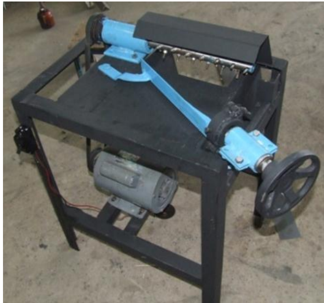
รูปที่ 3.13 การประกอบเครื่องปอกเปลือกหน่อไม้ที่ผ่านการพ่นสีป้องกันสนิม
