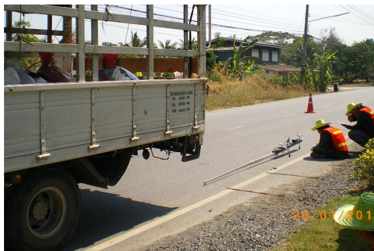
รูป 2-3 เครื่องมือเบนเคลแมนบีมในการใช้งานทดสอบ
