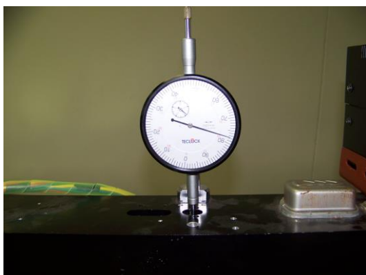
รูป ข-4 เปรียบเทียบตำแหน่งการติดตั้งอุปกรณ์วัดค่าการแอ่นตัวแทนนาฬิกาวัด
