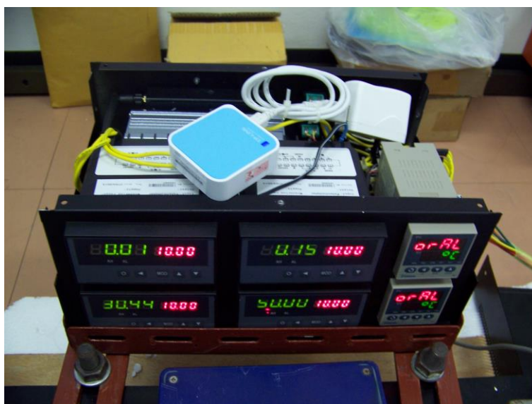
รูป ข-6 ส่วนประกอบภายในของกล่องควบคุมอิเล็กทรอนิกส์
