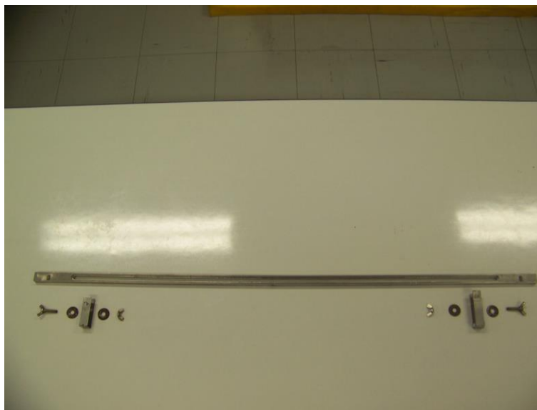
รูป ข-1 ชุดรางเลื่อนสำหรับยึดจับอุปกรณ์วัดค่าการแอ่นตัว
