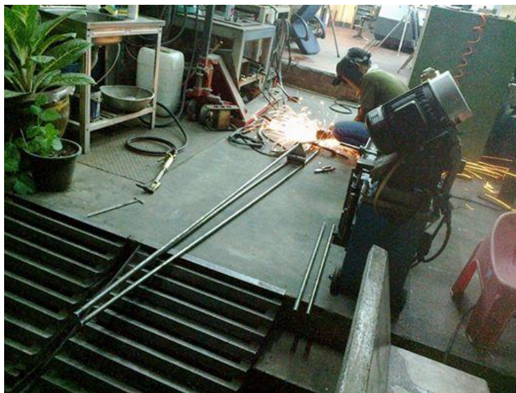
รูป ข-7 การสร้าง โครงเครื่องมือต้นแบบ
