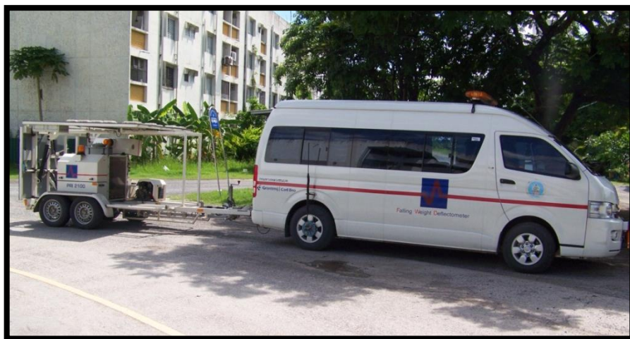
รูป 1-1 เครื่องมือวัดค่าการแอ่นตัวจากตุ้มกระแทกที่นำเข้าด้วยราคาสูงและมีใช้เฉพาะหน่วยงานหลัก
