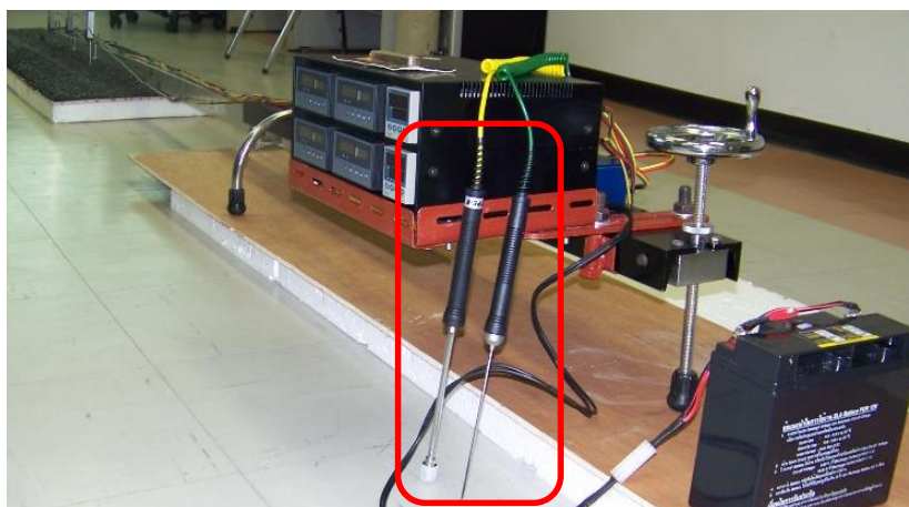
รูป 4-6 อุปกรณ์ตรวจวัดอุณหภูมิที่ผิวบนสุดและกึ่งกลางชั้นแอสฟัลต์คอนกรีต
