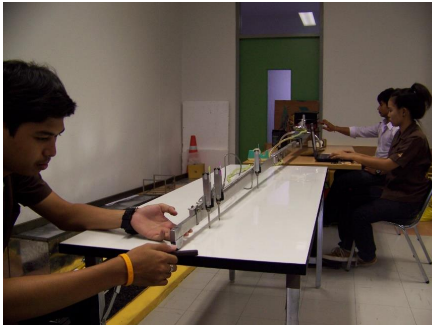
รูป 3-1 การสอบเทียบความเที่ยงตรงของอุปกรณ์วัดค่าการแอ่นตัวด้วยฟิลเลอร์เกจ
