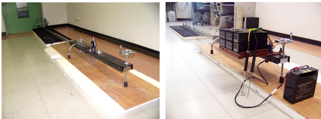
รูป ข-5 การติดตั้งอุปกรณ์ส่วนควบสำหรับเครื่องมือเบนเคลแมนบีมเชิงพาณิชย์
