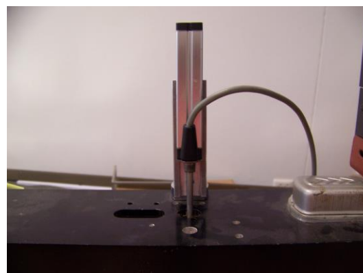
รูป ข-4 เปรียบเทียบตำแหน่งการติดตั้งอุปกรณ์วัดค่าการแอ่นตัวแทนนาฬิกาวัด
