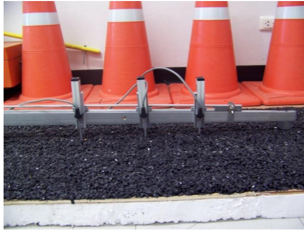
รูป 4-3 การติดตั้งอุปกรณ์ส่วนควบสำหรับเครื่องมือเบนเคลแมนบีมเชิงพาณิชย์
