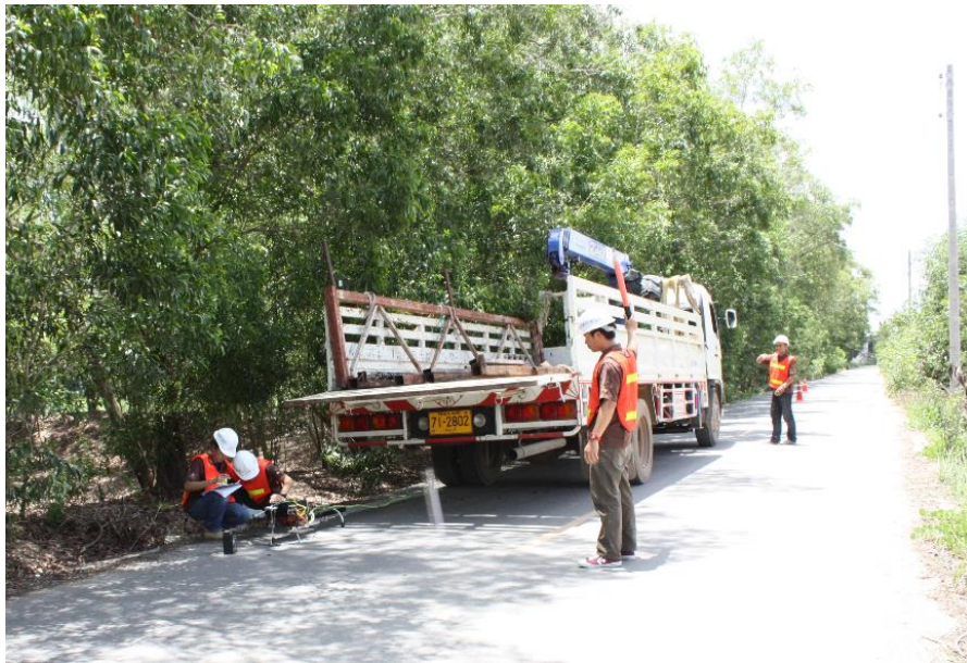
รูป 3-2 การทดสอบเครื่องมือเบนเคลแมนบีบบางกึ่งอัตโนมัติต้นแบบในสนาม
