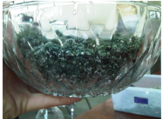
รูปที่ 4.4 จุลินทรีย์ผสมที่เกิดขึ้นในการหมักแข็งลำต้นสดข้าวฟ่างหวานด้วยเชื้อจุลินทรีย์ผสมโดยใช้ 100 กรัม น้ำหนักข้าวฟ่างในอาหารเหลว พีเอช 5 ปริมาตร 60 มิลลิลิตร
