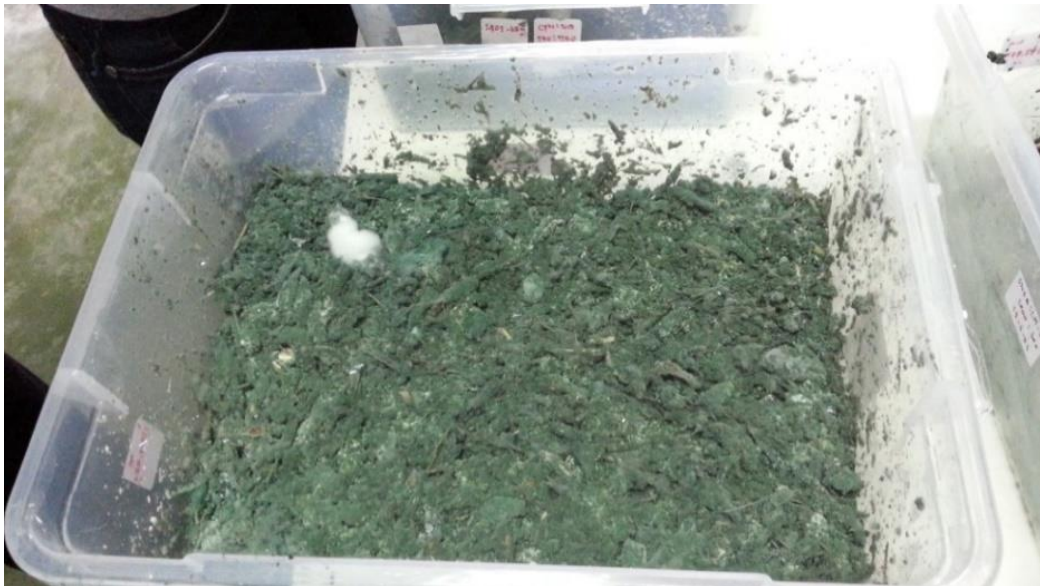
รูปที่ 4.5 จุลินทรีย์ผสมที่เกิดขึ้นในการหมักแข็งลำต้นสดข้าวฟ่างหวานด้วยเชื้อจุลินทรีย์ผสมโดยใช้ 600 กรัม น้ำหนักข้าวฟ่างในอาหารเหลว พีเอช 5 ปริมาตร 360 มิลลิลิตร
