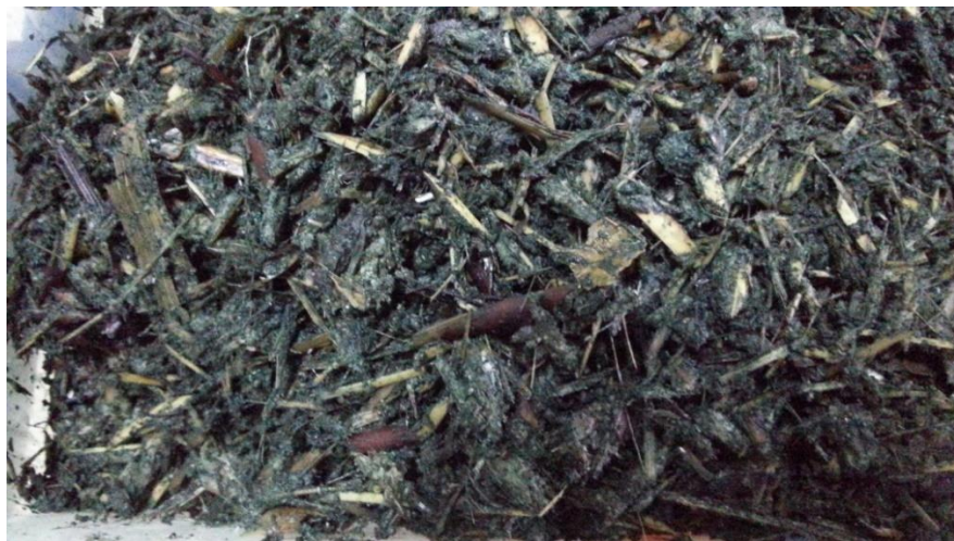
รูปที่ 4.7 จุลินทรีย์ผสมที่เติบโตได้บนแกนกลางของลำต้นสลดข้าวฟางหวานที่มีขนาดเล็ก แต่ไม่สามารถเติบโตในส่วนลำต้นที่มีความแข็งได้ถึงแม้จะมีขนาดเล็ก
