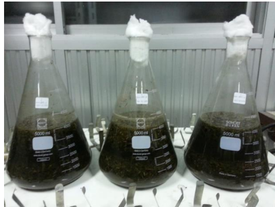
รูปที่ 4.9 การหมักเอทานอลกึ่งเหลวแบบกะจากลำต้นสดข้าวฟ่างหวานด้วยผงจุลินทรีย์ผสมที่สภาวะเหมาะสมในขวดรูปชมพู่ขนาด 5 ลิตร
