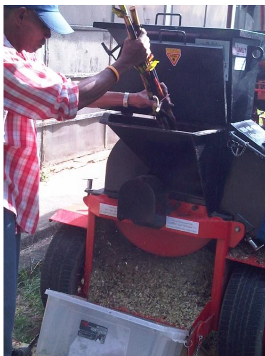
รูปที่ 3.5 การย่อยลดขนาดลำต้นสดข้าวฟ่างหวานที่แหล่งปลูก
