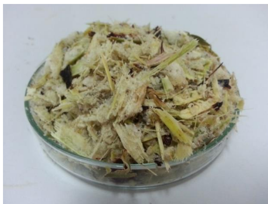
รูปที่ 3.6 ลำต้นสดข้าวฟ่างหวานที่ผ่านการย่อยก่อนนำไปใช้ในการหมัก
