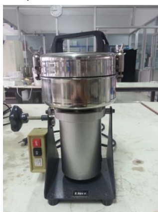
รูปที่ 3.15 เครื่องบดละเอียดต้นแบบของงานวิจัยนี้
