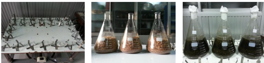
รูปที่ 3.17 การหมักเอทานอลกึ่งเหลวแบบกะจากต้นข้าวฟ่างหวานด้วยผงจุลินทรีย์ผสมในขวดรูปชมพู่ขนาด 5 ลิตร ที่สภาวะเหมาะสม
