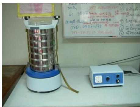
รูปที่ 3.9 เครื่องร่อนพร้อมตะแกรงเพื่อหาการกระจายขนาดอนุภาคลำต้นข้าวฟ่างหวานแห้ง
