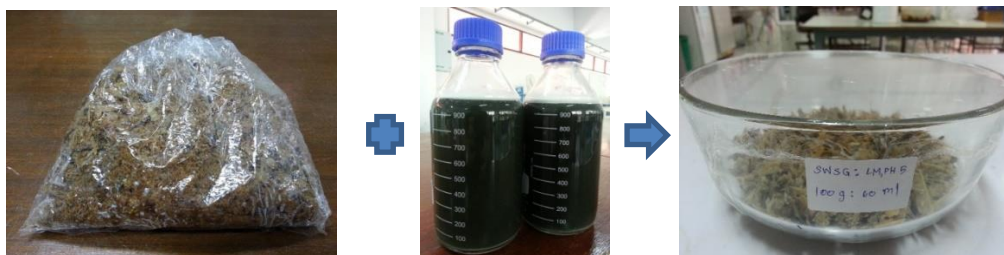
รูปที่ 3.12 การหมักแข็งลำต้นสคว้าวฟางหวานด้วยหัวเชื้อจุลินทรีย์ผสมในอาหารเหลว พีเอช 5
