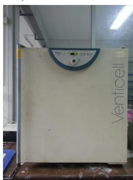
รูปที่ 3.14 ตู้อบลมร้อนสำหรับการอบแห้งจุลินทรีย์ผสม
