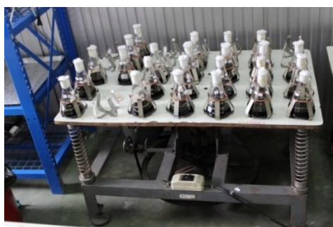
รูปที่ 3.16 การหมักเอทานอลถึงเหลวแบบกะจากต้นข้าวฟ่างหวานด้วยผงจุลินทรีย์ผสมในขวดรูปชมพู่ขนาด 250 มิลลิลิตร เพื่อหาสถานะเหมาะสม
