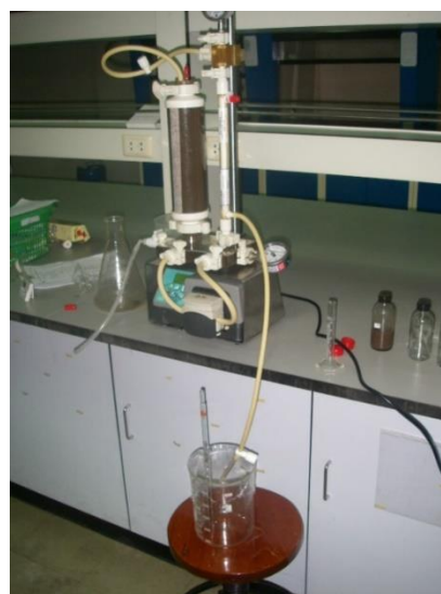
รูปที่ 3.21 การหมักเอทานอลกึ่งเหลวแบบกึ่งกะกับการรีไซเคิลจุลินทรีย์
