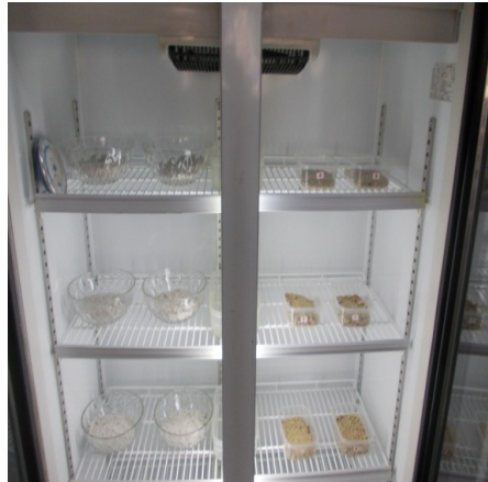
รูปที่ 3.9 การหมักแข็งกากกะทิด้วยจุลินทรีย์ผสมจากตลาดและโรงงานในตู้บ่มต้นแบบที่ 24 \pm 2^{\circ}\text{C}
