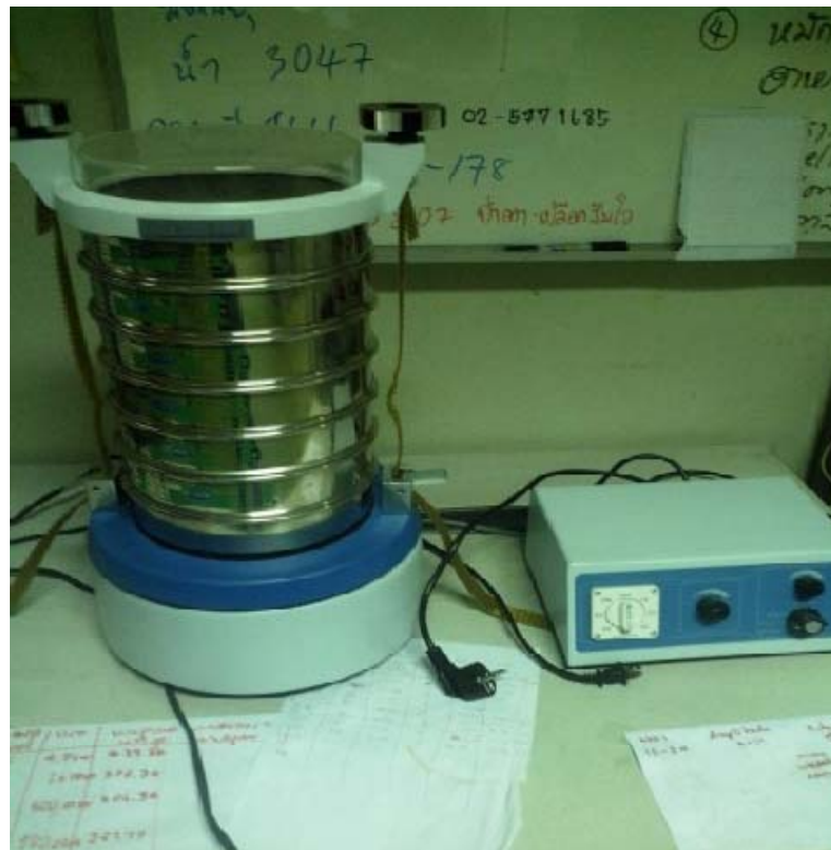
รูปที่ 3.2 เครื่องหาการกระจายขนาดอนุภาคกากกะทิโดยใช้ตะแกรงมาตรฐาน
