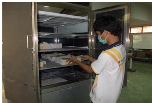
รูปที่ 3.15 การเรียงตะกร้าอบแห้งที่มีเอนไซม์ผสมเข้าเครื่องอบแห้งต้นแบบ
