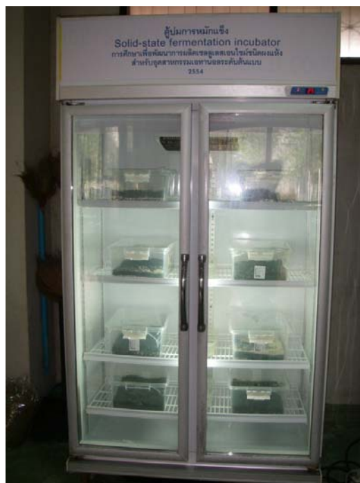
รูปที่ 3.12 การหมักแข็งกากกะทิจากตลาดในถังปฏิกรณ์ชีวภาพ ขนาด 10 ลิตร ด้วยหัวเชื้อผสม RT-P3 ในอาหารเหลวที่สภาวะเหมาะสมในตู้บ่มต้นแบบ
