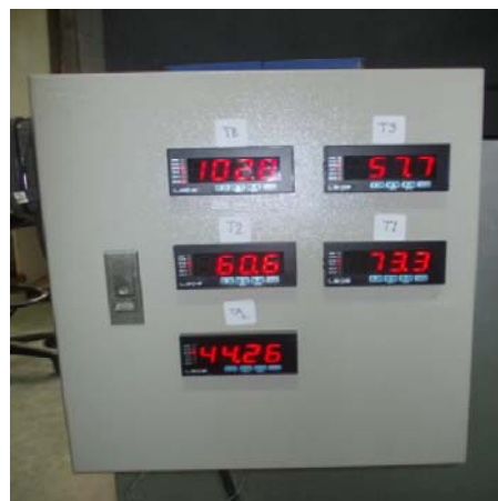
รูปที่ 3.17 ตัวควบคุมอุณหภูมิภายในเครื่องอบแห้งต้นแบบ
