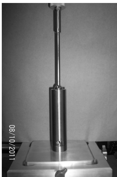
รูปที่ 3.1 แท่นวัดและหัววัดวิธีผลักดันย้อนกลับ (Back Extrusion)
