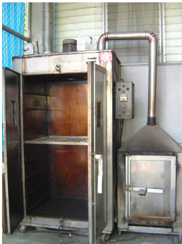
ภาพผนวกที่ ก2 ตู้รมควันแบบควบคุมอุณหภูมิ
