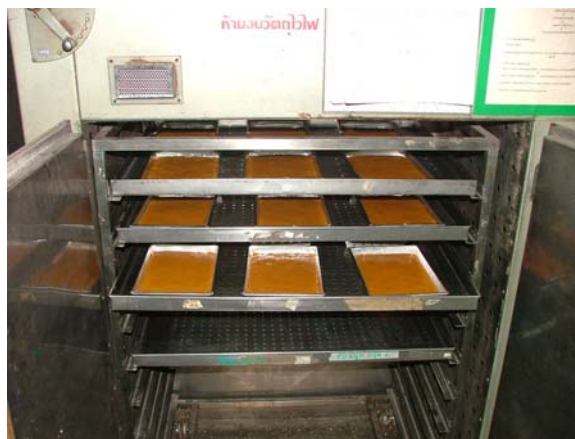
ภาพผนวกที่ ค 5 การอบแห้งพลาบแผ่นด้วยตู้อบแห้งแบบ cabinet dryer
