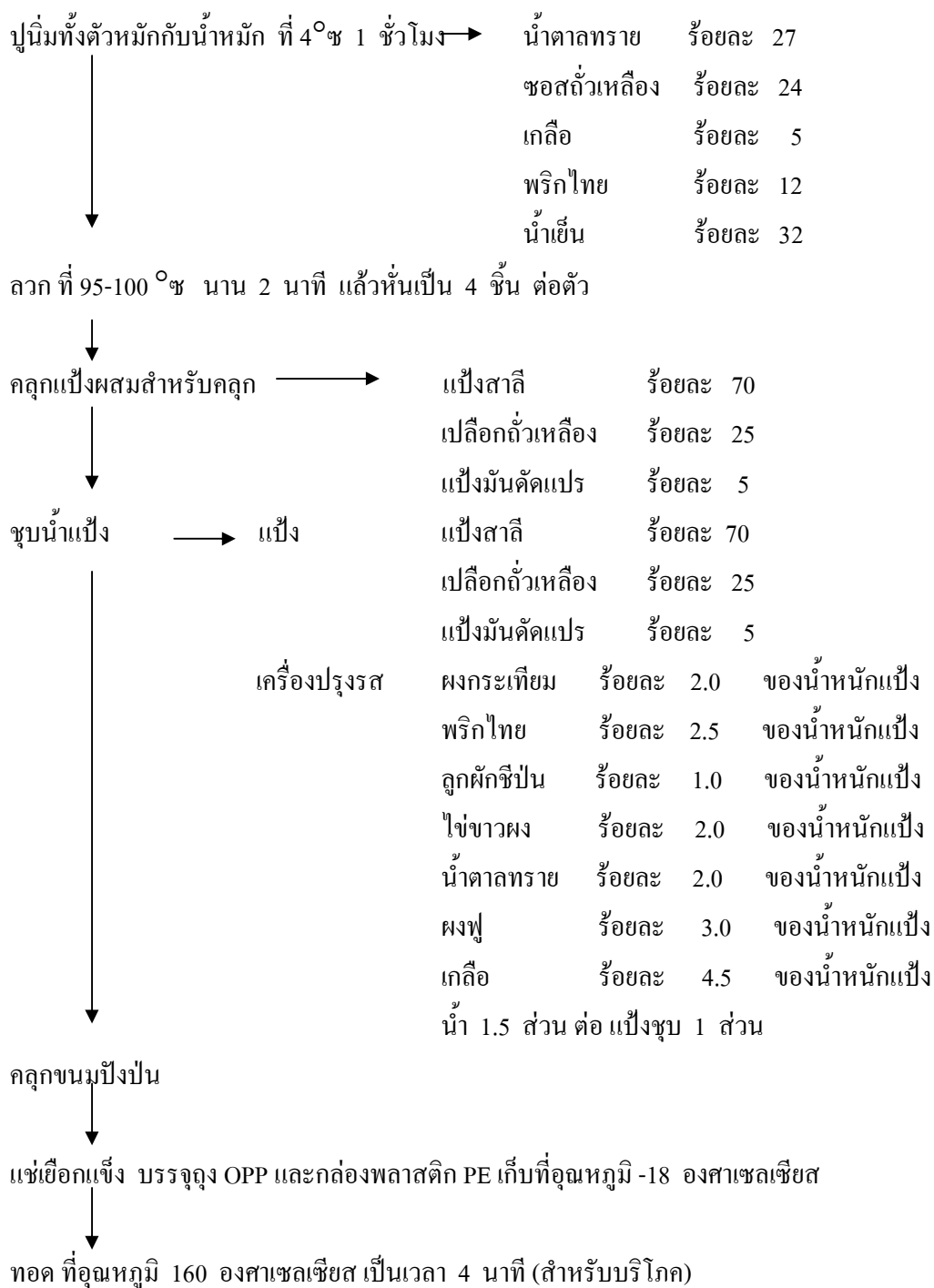
ภาพที่ 3 กระบวนการผลิตปูนิ่มชุบแป้งและขนมปังป่นเสริมใยอาหารที่ได้รับการพัฒนาแล้ว
