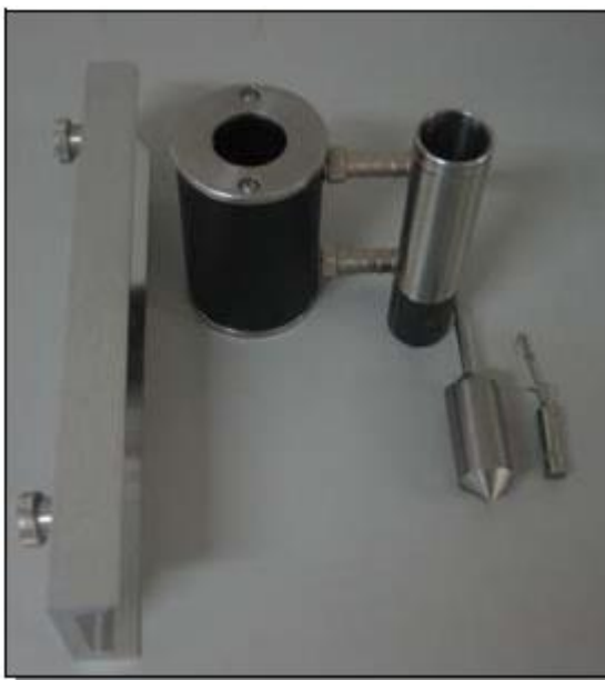
ภาพที่ ข5 อุปกรณ์ที่ใช้ในการวัดคือ หัววัดเบอร์ SC4-18 และ chamber
