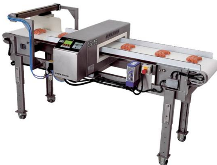
รูปที่ 2.5 ตัวอย่างของเครื่องมือที่ใช้ในการตรวจสอบโลหะ : http://www.packaging-equipment-sales.com/
