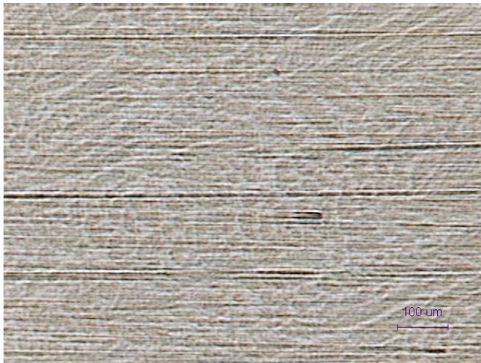
ภาพที่ 4.14 โครงสร้างจุลภาคของพิวเตอร์ชนิด 92Sn-8Sb
