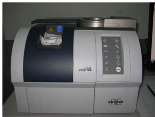
รูปที่ 3.5 เครื่อง FT-NIR Spectrometer (MPA, Bruker, Germany)
