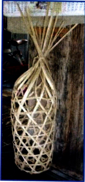
ภาพ 4.14 กว๋ยหิน (ชะลอม) วัสดุที่ใช้สร้างฝายในอดีต
