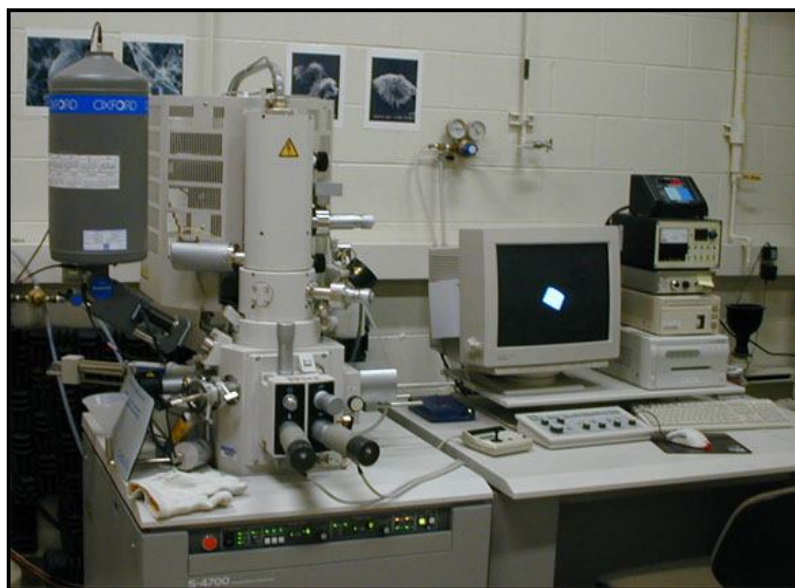
รูปที่ 3.9 กล้องจุลทรรศน์อิเล็กตรอนแบบเลื่อนกราดชนิดField Emission (FE-SEM) , Hitachi รุ่น S4700
