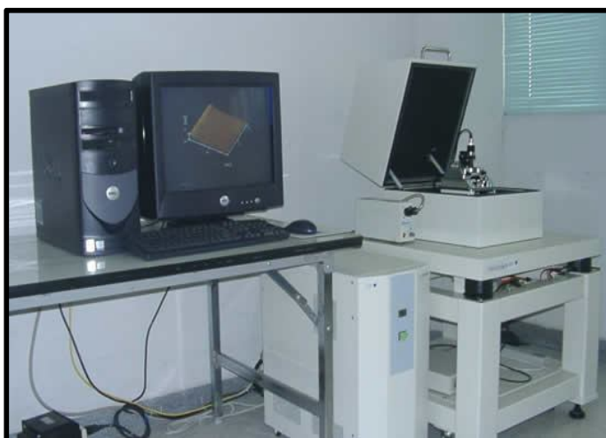
รูปที่ 3.10 กล้องจุลทรรศน์อิเล็กตรอนแบบแรงอะตอม(AFM), Seiko SPA-400
