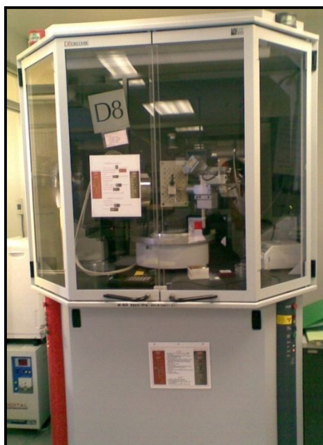
รูปที่ 3.8 เครื่อง X-Ray Diffractometer (XRD), Bruker รุ่น D8 Discover with GADDS
