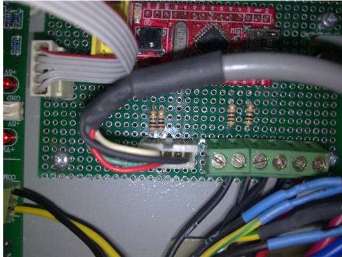
รูปที่ 3.10 จุดเชื่อมต่อรับสัญญาณจากเอนโค้ดเดอร์และ PC
