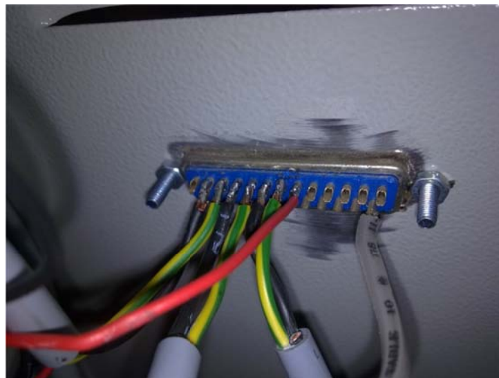
รูปที่ 3.9 จุดเชื่อมต่อรับสัญญาณจาก PC ด้วยพอร์ตปรีนเตอร์
