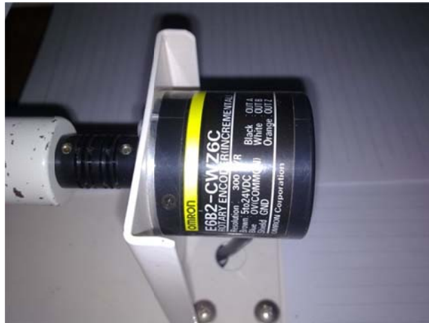
รูปที่ 2.13 เอนโค้ดเดอร์ที่ใช้ในงานอุตสาหกรรมทั่วไป
