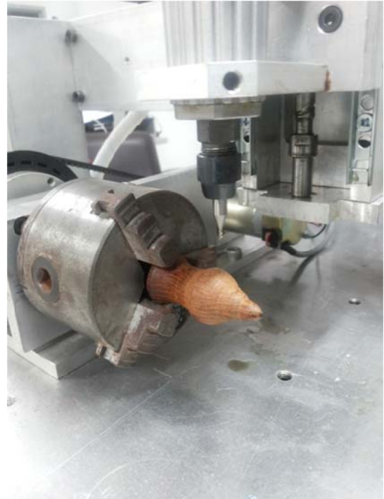
รูปที่ 4.2 การกัดชิ้นงานที่ได้จากการออกแบบ
