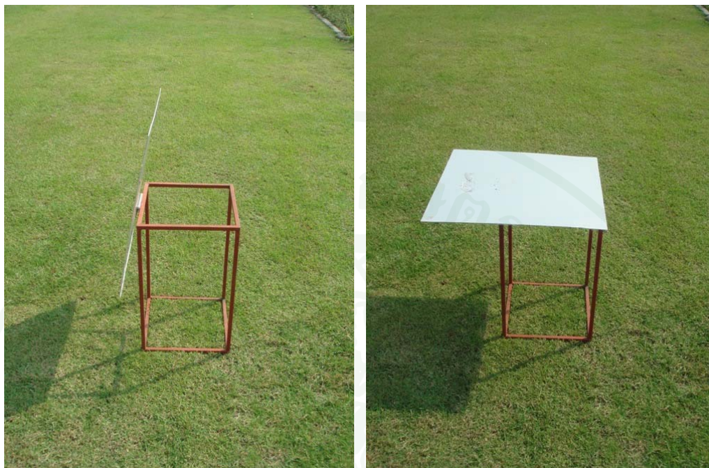
ภาพที่ 22 แผ่นทดลองอลูมิเนียมอะโนไดซ์ (Anodized Aluminum) หนา 1 มิลลิเมตร ประยุกต์การวางแนวระนาบในตอนกลางคืนและแนวตั้งฉากในตอนกลางวัน
