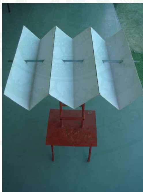
ภาพที่ 66 รูปแบบการประยุกต์การพับแผ่นวัสดุเพื่อการคายรังสีความร้อนในตอนกลางคืน ในระดับความสูง 0.50 ม.จากพื้นหญ้า
