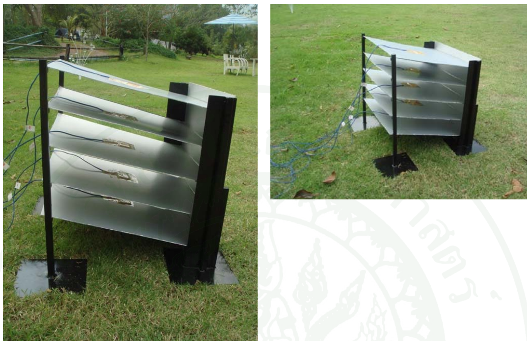
ภาพที่ 23 แผ่นทดลองอลูมิเนียมอะโนไดซ์ (Anodized Aluminum) หนา 1 มิลลิเมตร การวางแนวระนาบทำมุม 15 องศาขึ้นชันความสูง 0.50 เมตร
