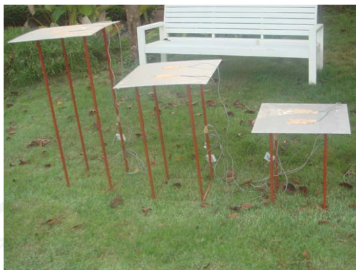
ภาพที่ 29 แผ่นทดลองอลูมิเนียมอะโนไดซ์ (Anodized Aluminum) หนา 1 มิลลิเมตร วางแนวระนาบในระดับต่างๆ 0.50 ม., 0.75 ม. และ 1.00 ม.
