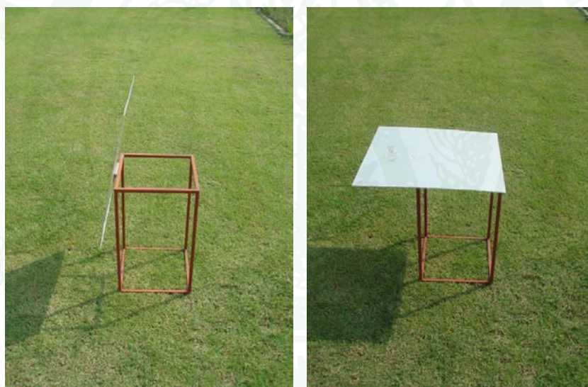
ภาพที่ 44 แผ่นทดลองอลูมิเนียมอะโนไดซ์ (Anodized Aluminum) หนา 1 มม. วางแนวระนาบและแนวตั้งฉากกับพื้นหญ้า
