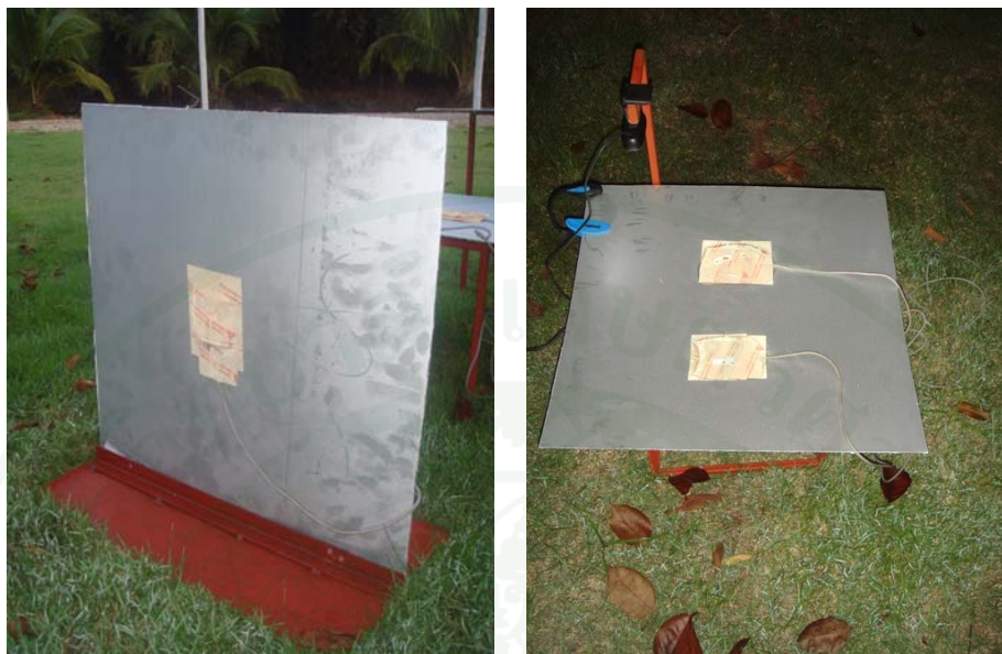
ภาพที่ 21 แผ่นทดลองอลูมิเนียมอะโนไดซ์ (Anodized Aluminum) หนา 1 มิลลิเมตร วางแนวระนาบและแนวตั้งฉากกับพื้นหญ้า
