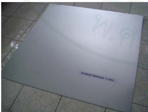
ภาพที่ 12 แผ่นทดลอง : อลูมิเนียมอะโนไดซ์ (Anodized Aluminum) หนา 1 มิลลิเมตร
