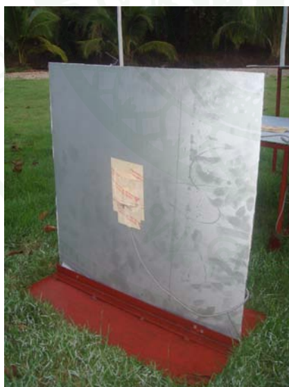
ภาพที่ 37 แผ่นทดลองอลูมิเนียมอะโนไดซ์ (Anodized Aluminum) หนา 1 มม. วางแนวระนาบในระดับ 0.50 ม. และวางแนวตั้งฉากกับพื้นสนามหญ้า
