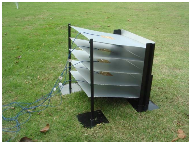
ภาพที่ 50 แผ่นทดลองอลูมิเนียมอะโนไดซ์ (Anodized Aluminum) หนา 1 มม. วางทำมุม 15 องศา กับแนวระนาบซ้อนชั้น
