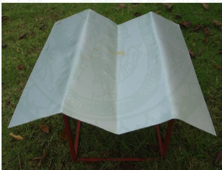
ภาพที่ 56 รูปแบบการพับแผ่นวัสดุอลูมิเนียมอะโนไดซ์ (Anodized Aluminum) หนา 1 มม. ขนาดพื้นที่ 0.50 ม. x 0.50 ม.
