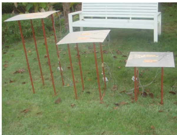
ภาพที่ 20 แผ่นทดลองอลูมิเนียมอะโนไดซ์ (Anodized Aluminum) หน้า 1 มิลลิเมตร ในระดับต่างๆ 0.50 เมตร 0.75 เมตร และ 1.00 เมตร
