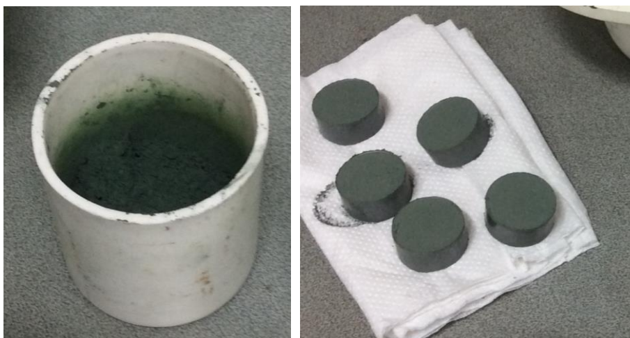
รูปที่ 4.1 ผงและตัวอย่างสารประกอบ \text{CuCrO}_2 ที่ผ่าน Calcine และ Sinter
