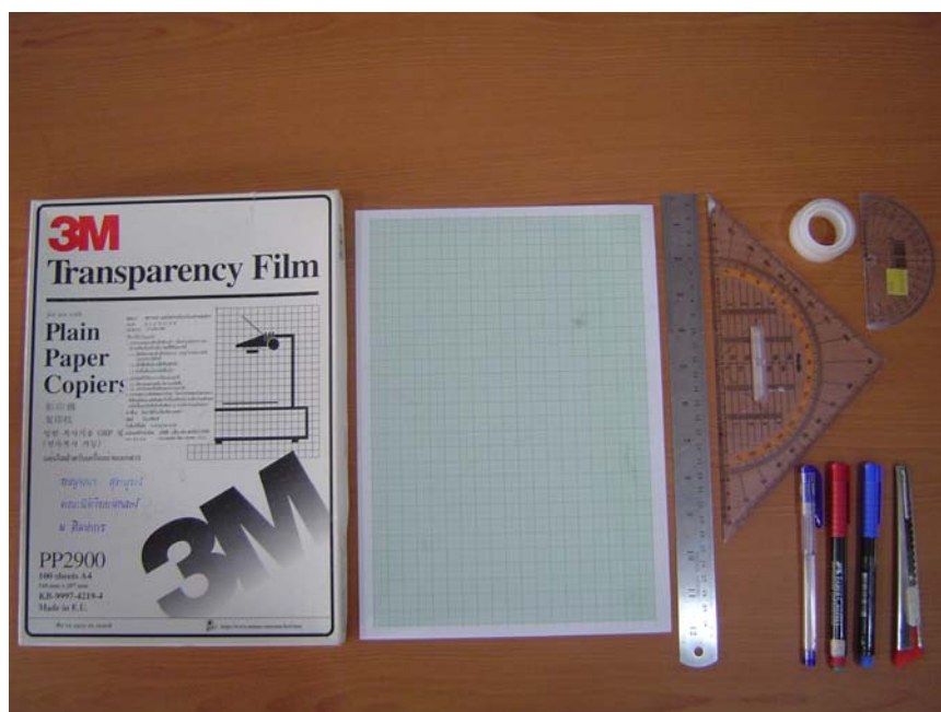
ภาพที่ 58 อุปกรณ์สำหรับการเก็บข้อมูลและวัดรอยเท้า ได้แก่ แผ่นใสสำหรับถ่ายเอกสาร 3M, กระดาษกราฟขนาด 1 ตารางมิลลิเมตร, ไม้บรรทัดบอกสเกลระดับมิลลิเมตร, เครื่องมือวัดมุม, เทปกาวยึด 3M, ปากกาเขียนแผ่นใสแบบถาวรและคัดเตอร์
