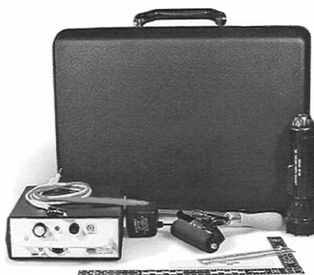
ภาพที่ 12 แสดงภาพเครื่องลอกรอยด้วยระบบไฟฟ้าสถิต (Electrostatic Lifting)
