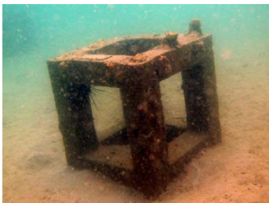
รูปที่ 1 โครงสร้างซีเมนต์ ขนาด 50 \times 50 \times 50 เซนติเมตร ที่ใช้ยึดติดปะการังสำหรับการทดลอง จำนวน 8 โคโลนี/ โครงสร้าง ซึ่งวางในทะเล โดยจำแนกตามชุดไม่ครอบกรง (ซ้าย) และ ชุดครอบกรง (ขวา)
