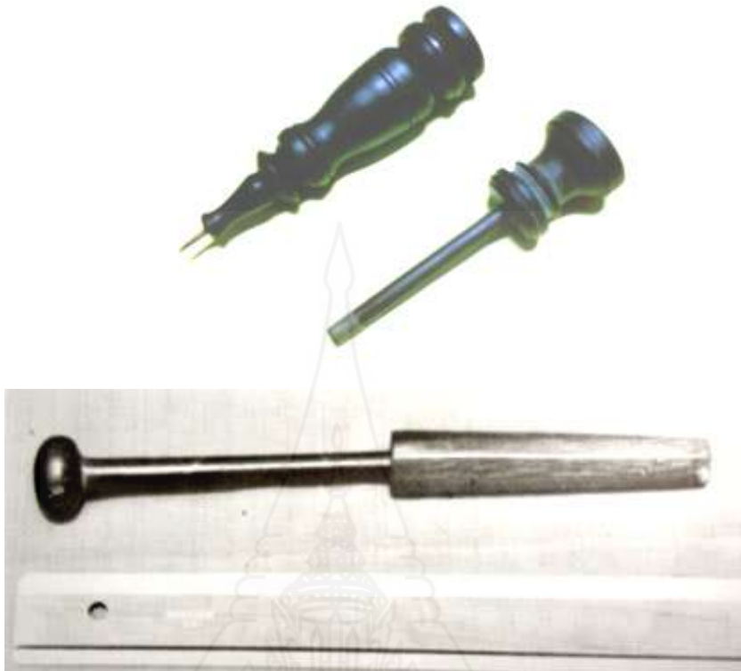
ภาพที่ ๔๘ ตะบันไฟ
