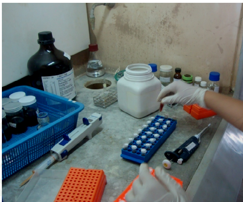
ภาพผนวกที่ 9 นำสารละลายที่ได้จากเครื่องปั่นเหวี่ยงเดิมสารเคมีเพื่อเข้าเครื่องวัดค่าการดูดกลืนแสงเพื่อคำนวณหาปริมาณสารพิษกอสชิปอล
