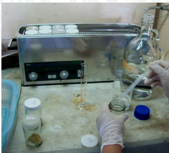
ภาพผนวกที่ 6 เนื้อในของเมล็ดฝ้ายบดที่เติมสารเคมีในการสกัดแล้วเขย่าในเครื่องเขย่าสารโดยใช้เสียงความถี่สูงเป็นเวลา 30 นาที
