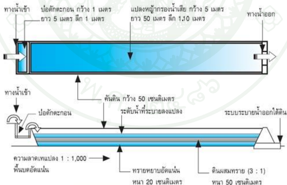
ภาพที่ 30 ลักษณะรูปแบบเทคโนโลยีการบำบัดน้ำเสียด้วยระบบหญ้ากรองน้ำเสีย
