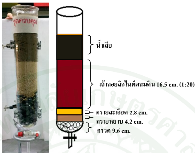
ภาพที่ 37 คอลัมน์บรรจุวัสดุเพาะปลูกตามแบบพื้นที่เพาะปลูกของระบบพื้นที่ชุ่มน้ำเทียม และระบบ หน่วยกรองน้ำเสีย
