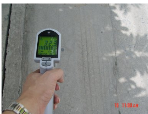
พื้นถนนเทคอนกรีตใต้เงาซุ้มไม้เลื้อย 32.3 องศาเซลเซียส
