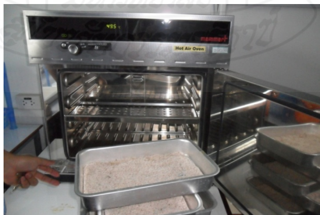
ภาพผนวกที่ ข3 การนำกากมะพร้าวไปอบเพื่อกำจัดความชื้น
