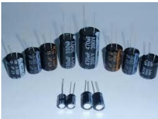
ภาพที่ 3.7 ตัวเก็บประจุชนิดอิเล็กโทรไลต์ขนาดความจุต่างๆ
