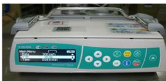
ภาพที่ 3.41 การทดสอบการ Prime IV SET
