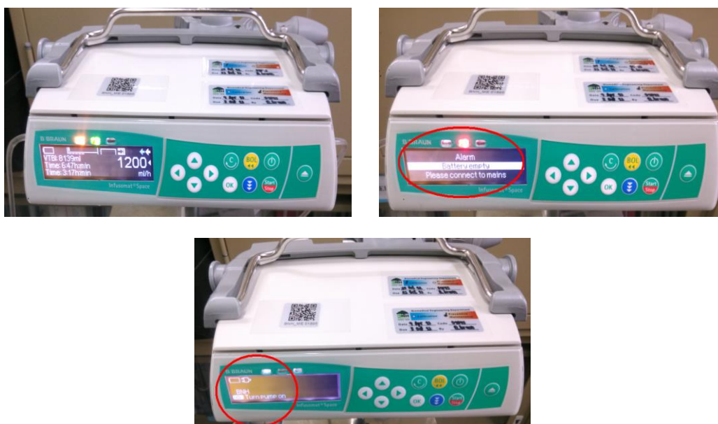
ภาพที่ 3.17 Battery ใช้งานไม่ได้ก่อนการดำเนินการวิจัย
