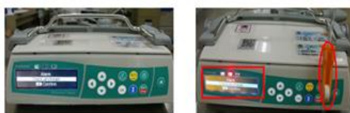
ภาพที่ 3.42 ทดสอบ Pressure Up Stream Alarm
