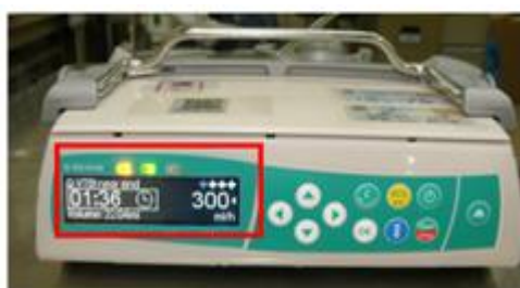
ภาพที่ 3.45 ทดสอบ Nearly Empty Alarm
