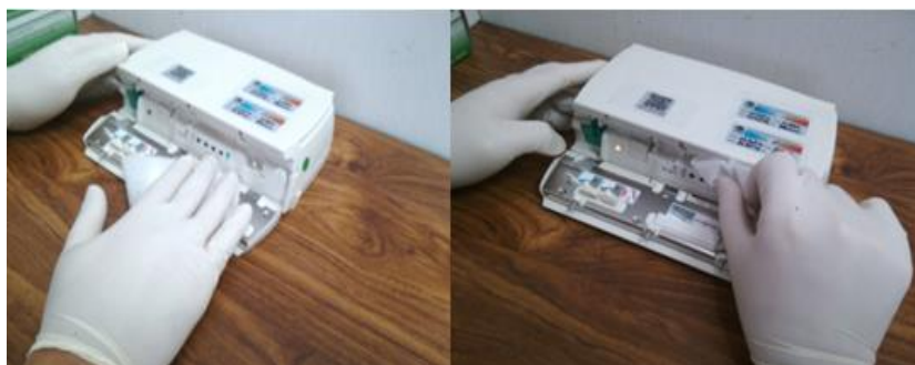
ภาพที่ 3.22 การทำความสะอาด Sensor Air ก่อนการทดสอบการทำงาน
