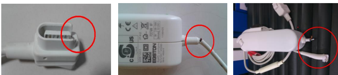
ภาพที่ 3.26 Adaptor หักชำรุดไม่พร้อมใช้งานก่อนการดำเนินการวิจัย
