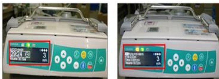
ภาพที่ 3.46 ทดสอบ End of Alarm
