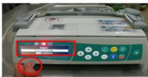
ภาพที่ 3.43 ทดสอบ Pressure Downstream Alarm
