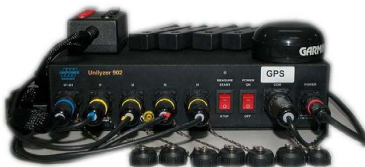
ภาพที่ 12 เครื่องตรวจวัดคุณภาพกำลังไฟฟ้าผลิตภัณฑ์ Unipower รุ่น U902
