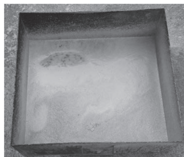
ภาพที่ 1 ถาดสี่เหลี่ยมที่ใช้บรรจุน้ำมันในการทดสอบปริมาตรความจุ 475 x 475 x 200 มิลลิเมตร
