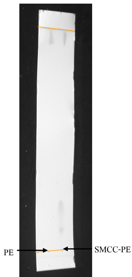
ภาพที่ 17 ผลการเคลื่อนที่บนตัวกลางของฟอสฟาติดิลเอธานอลามีน (PE) ก่อนและหลังการเชื่อมด้วย sulfo-SMCC cross linker (SMCC-PE) โดยใช้เทคนิค thin layer chromatography
