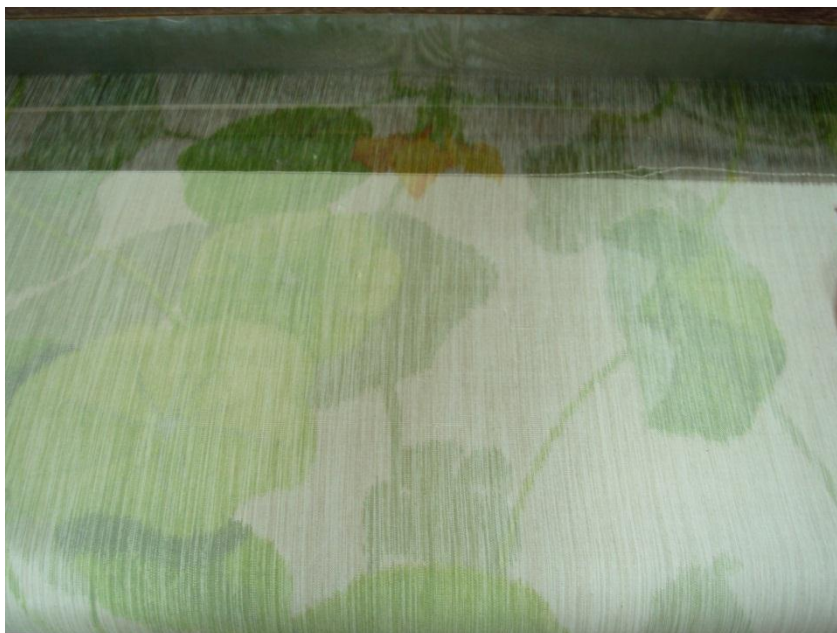
ภาพที่ 2.51 เปรียบเทียบเส้นยืนที่ได้รับการพิมพ์โดยระบบดิจิทัล และผ้าที่ทอออกมาจากเส้นยืนนั้นด้วยเส้นพุ่งสีขาวไม่มีลวดลาย
