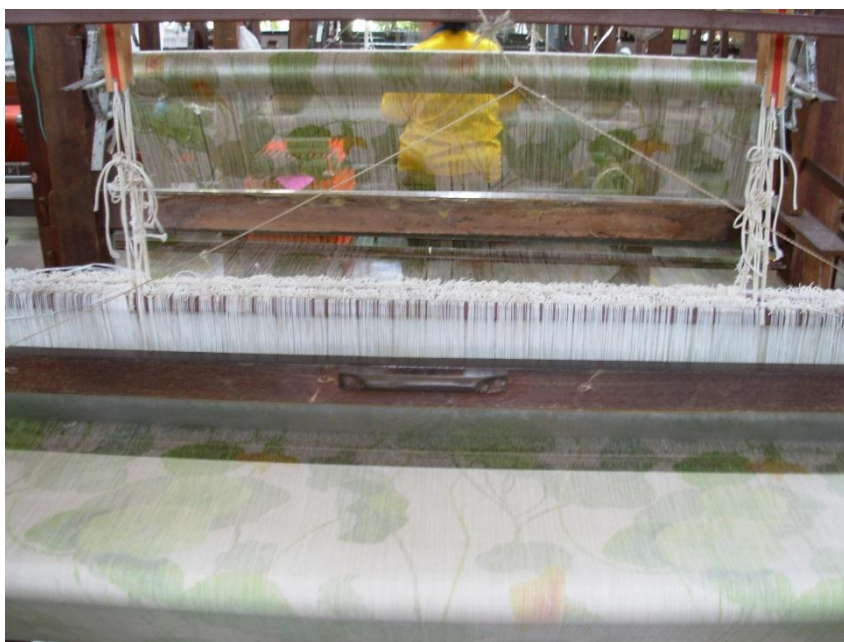
ภาพที่ 2.50 เปรียบเทียบเส้นยืนที่ได้รับการพิมพ์โดยระบบดิจิทัล และผ้าที่ทอออกมาจากเส้นยืนนั้นด้วยเส้นพุ่งสีขาวไม่มีลวดลาย
