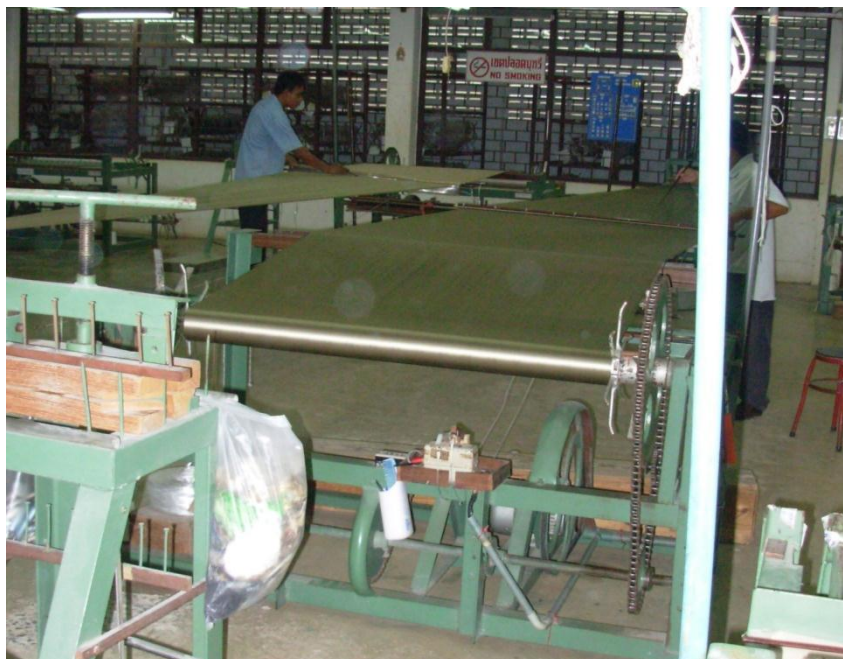
ภาพที่ 2.46 การเตรียมด้ายยืนก่อนที่จะนำไปพิมพ์ด้วยระบบดิจิทัล
