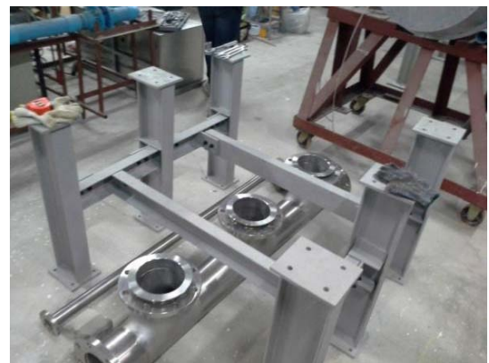
ภาพที่ 5.13 โครงสร้างห้องเผาไหม้เชื้อเพลิงชีวมวลผง [20]
