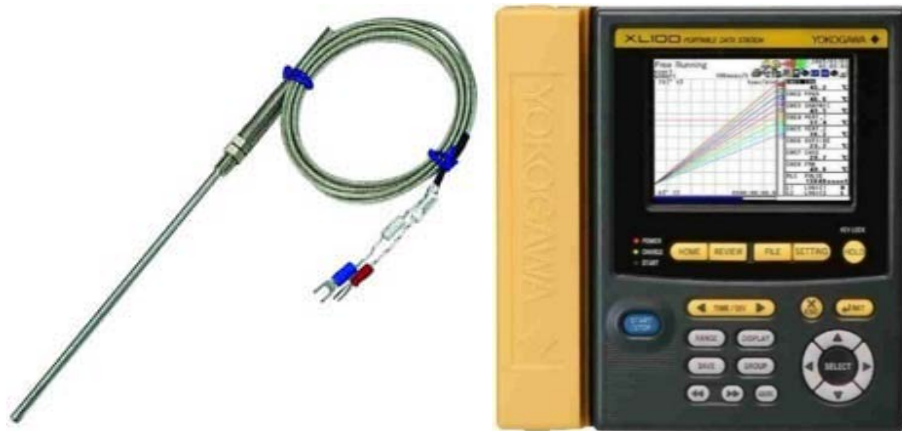
ภาพที่ 5.25 thermocouple type K และหน่วยแสดงผล YOKOGAWA XL 100
