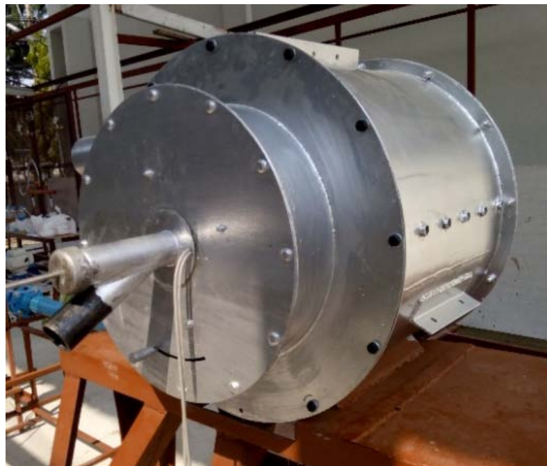
ภาพที่ 5.3 หัวเผาเชื้อเพลิงชีวมวลผงชนิดห้องเผาไหม้ช่วย (ด้านหลัง)
