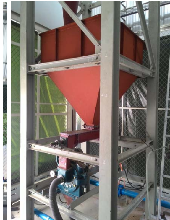
ภาพที่ 5.5 ลักษณะถังพักเชื้อเพลิงชีวมวลผง (hopper) และสกรูลำเลียงที่ติดตั้งเข้ากับโครงสร้าง
