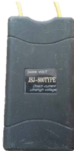
ภาพที่ 5.32 อุปกรณ์ขยายแรงดันไฟฟ้าสำหรับจุดประกายไฟ
