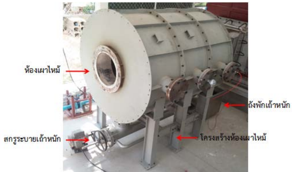
ภาพที่ 5.12 ลักษณะของห้องเผาไหม้เชื้อเพลิงชีวมวลผง
