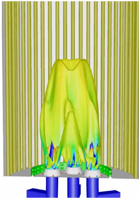
ภาพที่ 1.3 ผลการจำลองลักษณะของเปลวไฟในห้องเผาไหม้ (ที่มา : Optimization of Low-NOx Burner Installation through Simulation, Lanre Oshinowo, 2008)
