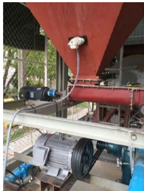
ภาพที่ 5.7 แสดงอุปกรณ์สร้างแรงสั่นสะเทือนด้วยลมที่เลือกใช้
