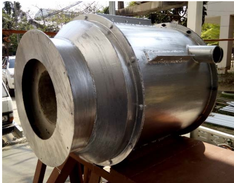
ภาพที่ 5.2 หัวเผาเชื้อเพลิงชีวมวลผงชนิดห้องเผาไหม้ช่วย (ด้านหน้า)
