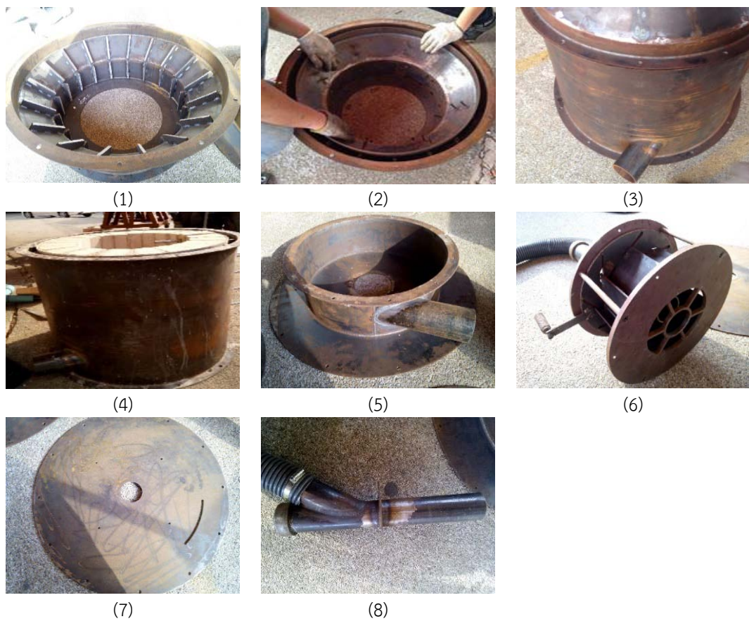
ภาพที่ 5.1 แสดงชิ้นส่วนหลักของหัวเผาเชื้อเพลิงชีวมวลผงชนิดห้องเผาไหม้ช่วย
