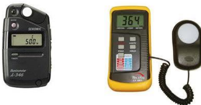
รูปที่ ก-2 ลักษณะของเครื่องวัดปริมาณแห่งการส่องสว่างซึ่งมี ฟุต-แคนเดลิเมตร และลักซ์มิเตอร์
