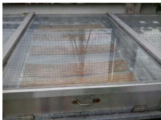
6. นำไปตากแดดด้วยตู้อบพลังงานแสงอาทิตย์
