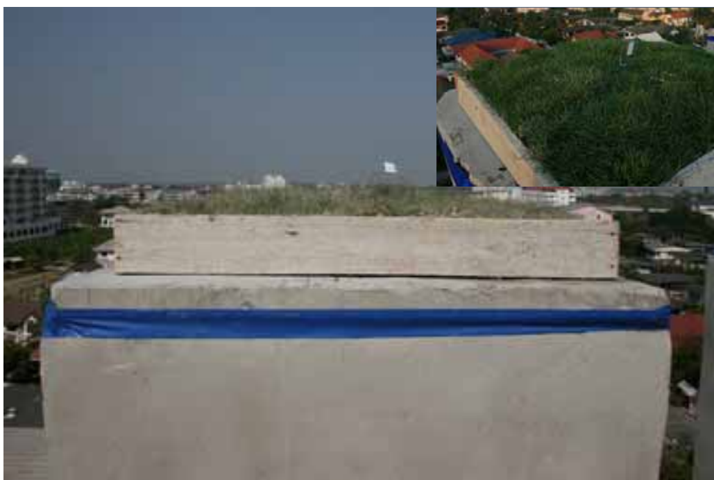
ภาพที่ 44 แสดงกล่องทดลองที่ 3 (หลังคาหญ้านวลน้อย ความลึกดิน 10 ซม.)
