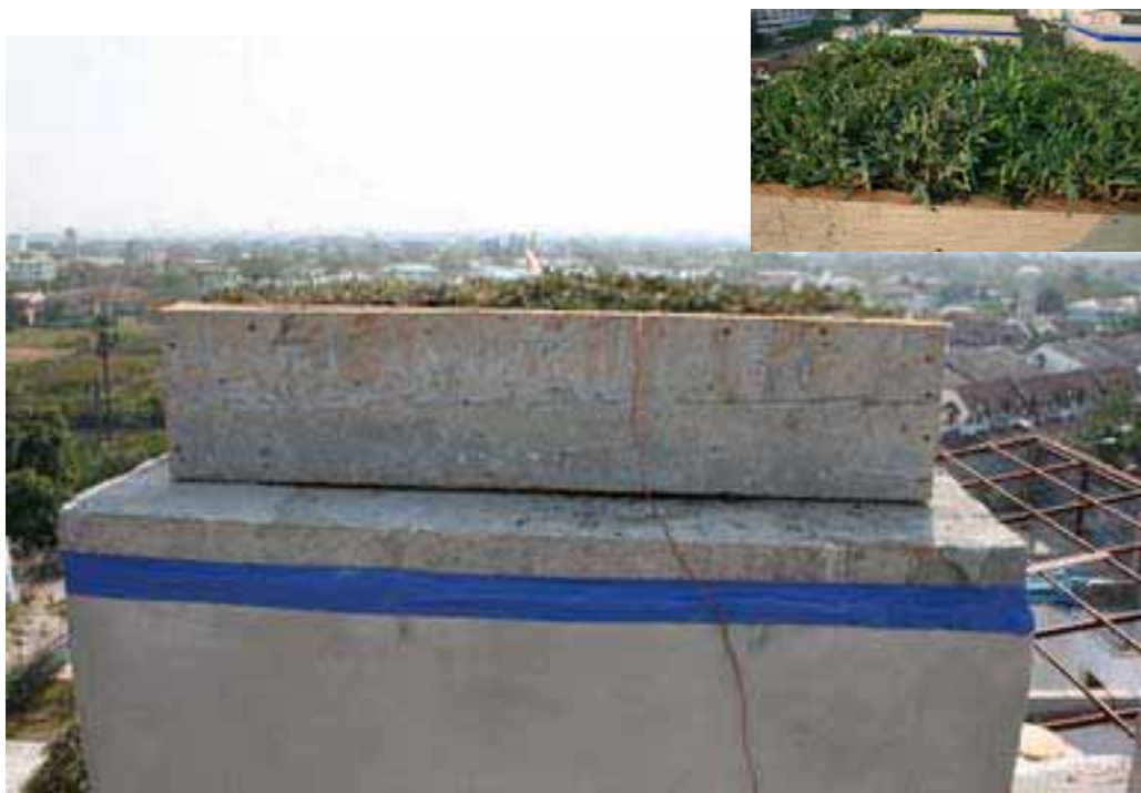
ภาพที่ 45 แสดงกล่องทดลองที่ 4 (หลังคาหญ้ามาเลเซีย ความลึกดิน 20 ซม.)
