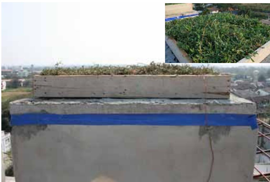
ภาพที่ 43 แสดงกล่องทดลองที่ 2 (หลังคาหญ้ามาเลเซีย ความลึกดิน 10 ซม.)
