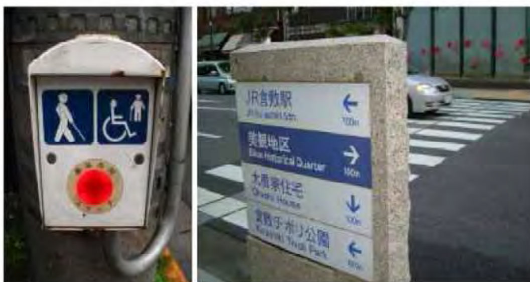
ภาพที่ 16 ป้ายบอกทางคำนึงถึงระดับสายตาการมองของผู้พิการรถเข็นอยู่ในตำแหน่งที่เห็นได้สะดวกและชัดเจน
