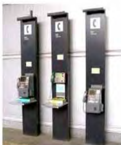
ภาพที่ 14 แสดงโทรศัพท์สาธารณะที่คำนึงถึงการใช้งานของผู้ใช้ที่มีความสูงที่ต่างกัน โดยจะสามารถเลื่อนปรับตำแหน่งขึ้นลงได้ตามความสูงของผู้มาใช้งาน
