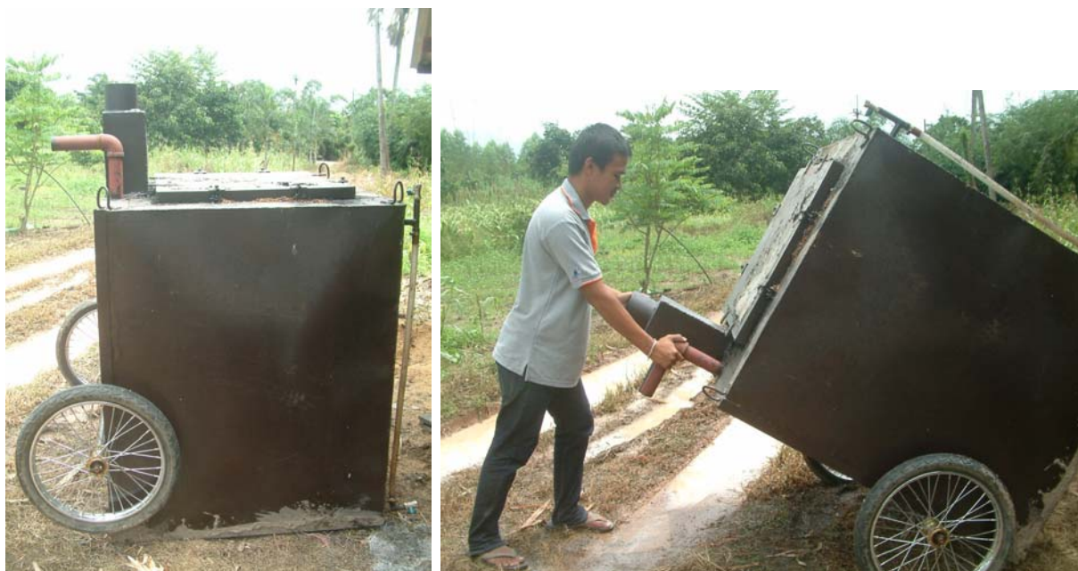
ภาพที่ 4.1 ลักษณะเตาเผาถ่านผลิตไอน้ำเคลื่อนที่ได้
