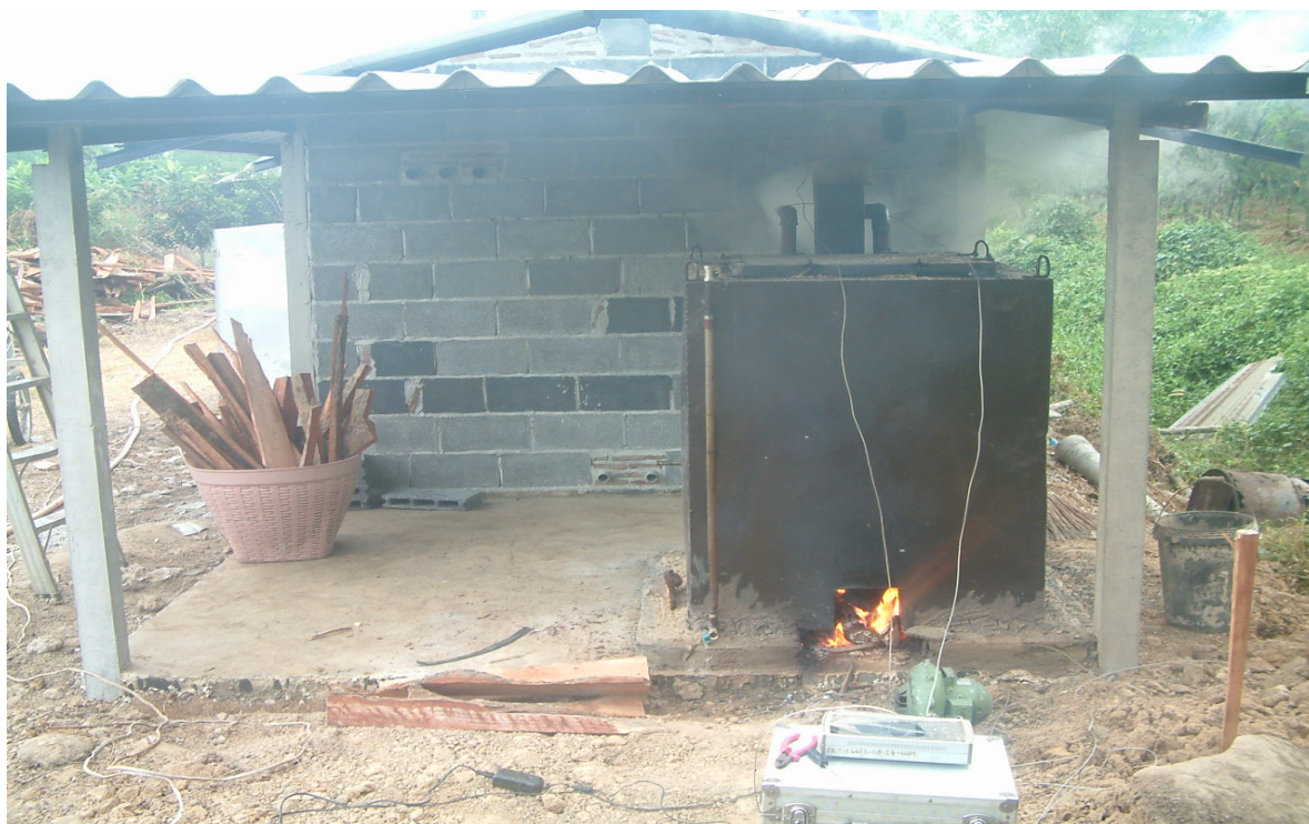
ภาพที่ 4.4 เตาเผาถ่านผลิตไอน้ำเคลื่อนที่ได้สำหรับโรงเรือนเพาะเห็ด
