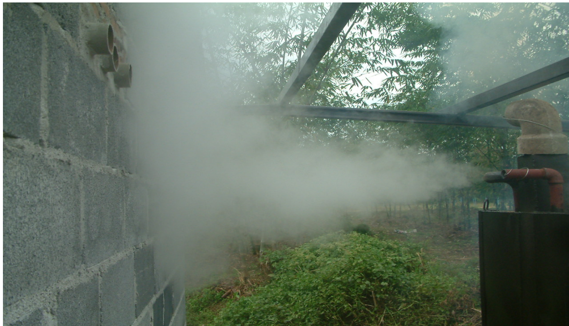
ภาพที่ 4.2 การทดสอบเตาเผาถ่านผลิตไอน้ำเคลื่อนที่ได้ต้นแบบ
