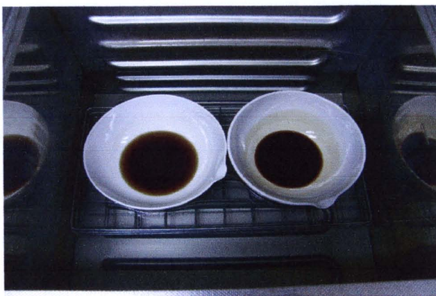
ค) ระเหยน้ำออกที่อุณหภูมิ 40 องศาเซลเซียสในอ่างควบคุมอุณหภูมิ
