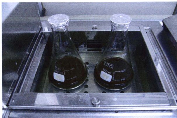
ก) ทำการสกัดสารที่อุณหภูมิ 80 องศาเซลเซียส เป็นเวลา 1 ชั่วโมง ในอ่างควบคุมอุณหภูมิ
