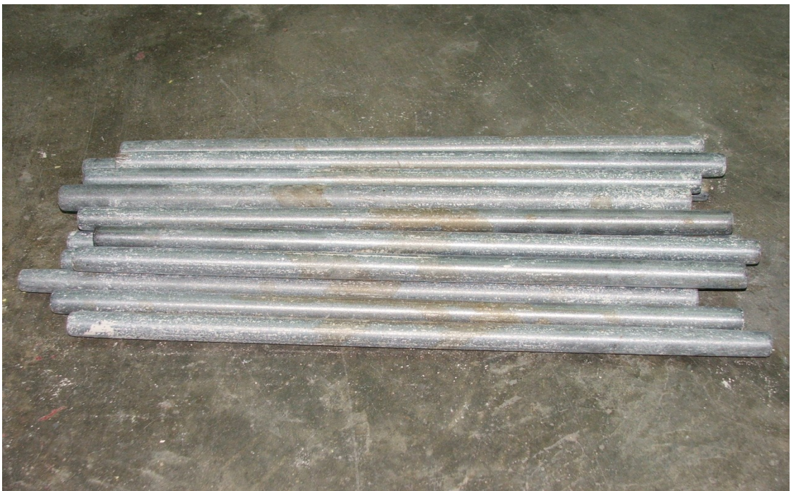
ภาพผนวกที่ ๑2 Rods Mill ขนาดเส้นผ่านศูนย์กลาง 2.25 ซม. ยาว 46 ซม.
