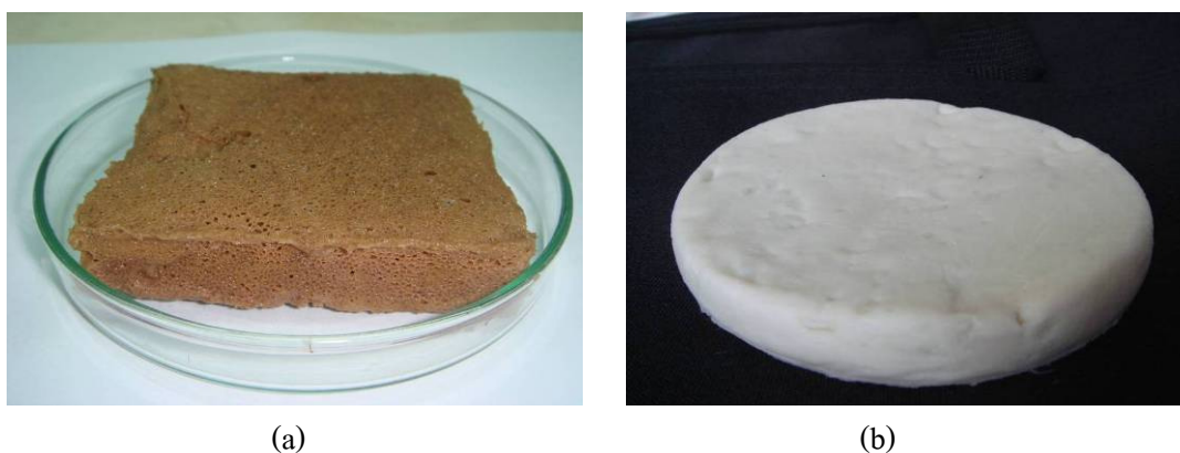
ภาพที่ 25 ฟองน้ำเส้นใยธรรมชาติที่ผลิตได้ (a) ผลิตจากฟางข้าวที่ยังไม่ผ่านการปรับสภาพ (b) ผลิตจากฟางข้าวที่ผ่านการปรับสภาพแล้ว
