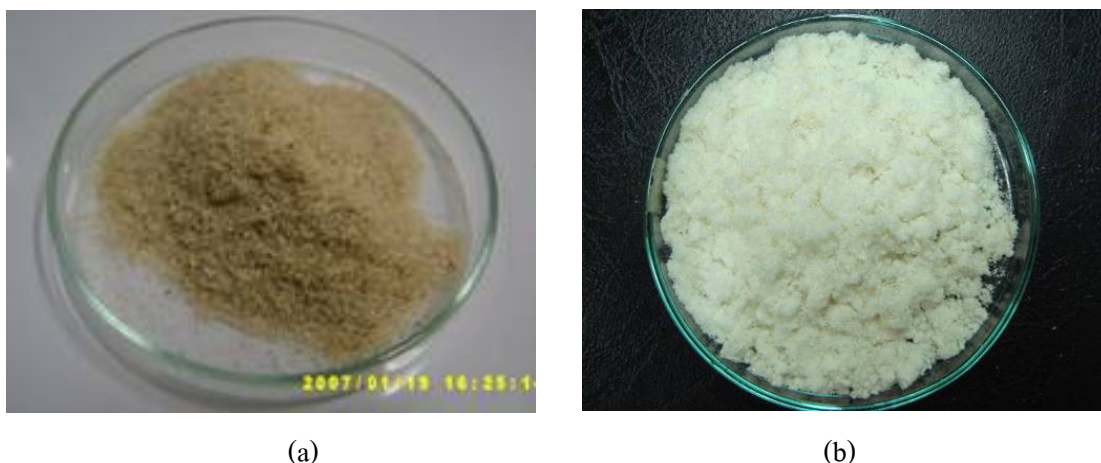
ภาพที่ 24 การปรับสภาพฟางข้าวโดยใช้สารละลายโซเดียมไฮดรอกไซด์ (a) ฟางข้าวก่อนการปรับสภาพ (b) ฟางข้าวหลังการปรับสภาพ
