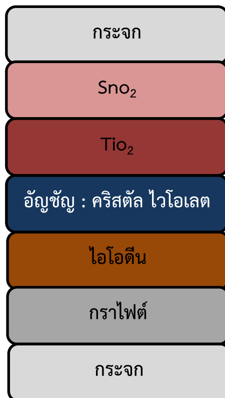
ภาพที่ 3.1 โครงสร้างของ DSSC
