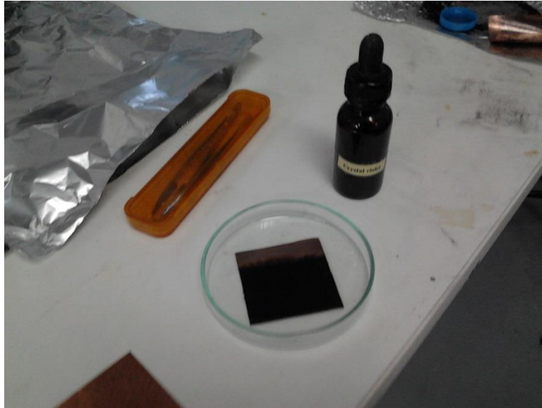
ภาพที่ ก.5 การทดสอบการจุ่มสีย้อมก่อนใช้งานจริง
