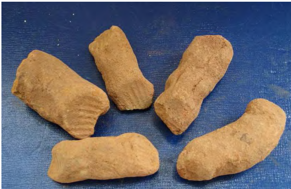
ภาพที่ 10 ก้อนดินเหนียวเป็นก้อนที่ช่วยจัดวางภายในเตาเผาเคลือบสี
