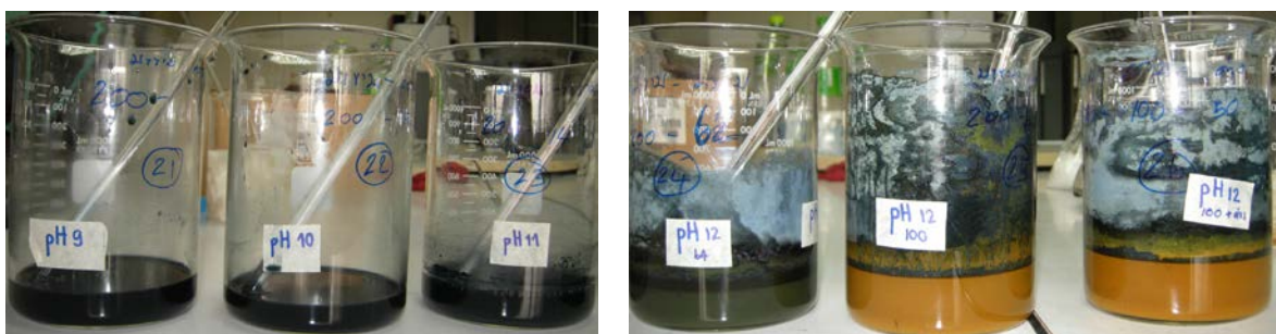
รูปที่ 12 กระบวนการย้อมครามต่างระดับความเป็นด่าง (จากซ้าย) pH 9, 10, 11, 12, 12 และ 12
