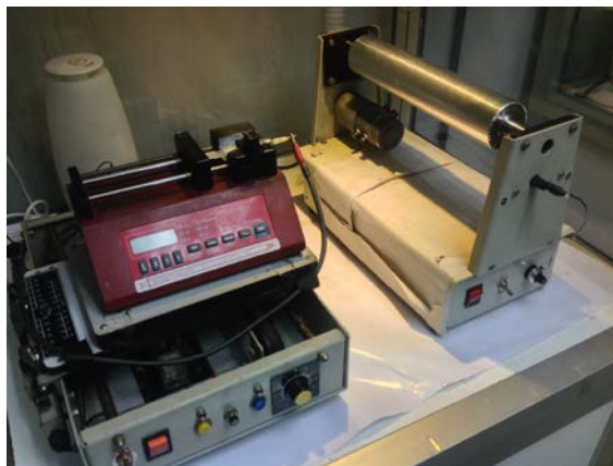
รูปที่ 7 การติดแผ่นอะลูมิเนียมสำหรับการเตรียมแผ่นเส้นใยชนิด aligned
