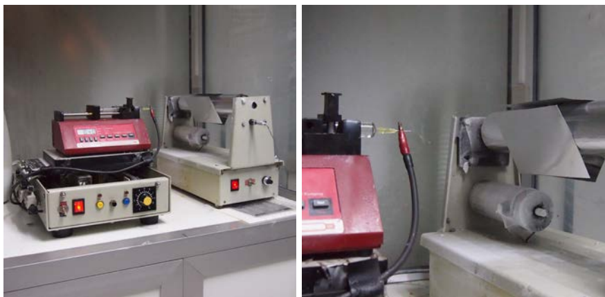
รูปที่ 2 การติดตั้งอุปกรณ์สำหรับกระบวนการอิเล็กโตรสปินนิ่งในห้องปฏิบัติการ
