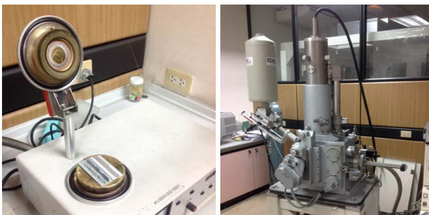
รูปที่ 3 การเตรียมตัวอย่างเพื่อถ่ายภาพด้วยกล้องจุลทรรศน์อิเล็กตรอน
