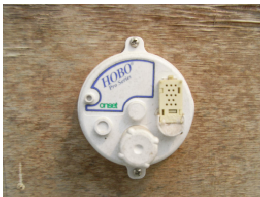
ภาพที่ 6 เครื่องวัดและบันทึกอุณหภูมิอัตโนมัติ (Data logger) รุ่น HOBO Pro Series
