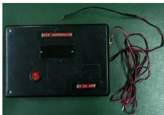
ภาพที่ 7 เครื่องวัดอุณหภูมิแบบดิจิทัลจากภาควิชาวิศวกรรมเครื่องกล คณะวิศวกรรมศาสตร์ กำแพงแสน มหาวิทยาลัยเกษตรศาสตร์ วิทยาเขตกำแพงแสน
