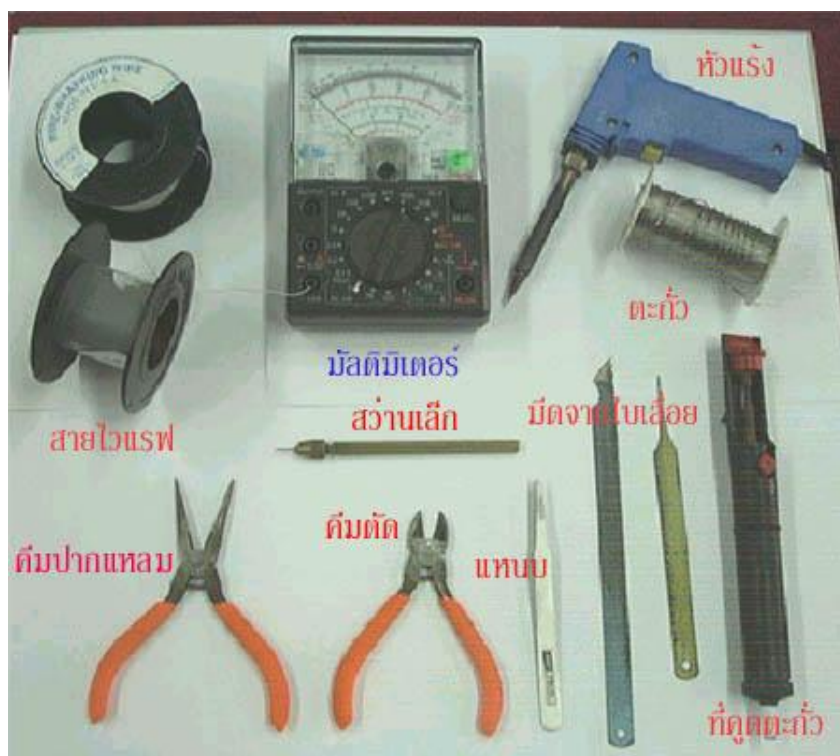
ภาพที่ 35 เครื่องมือที่ใช้ประกอบอุปกรณ์ลง PCB
